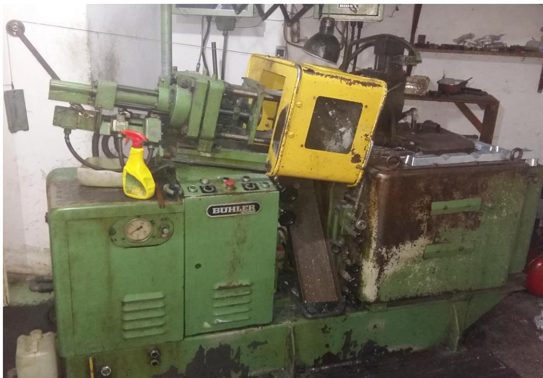
Slika 7. Stroj za tlačni lijev
