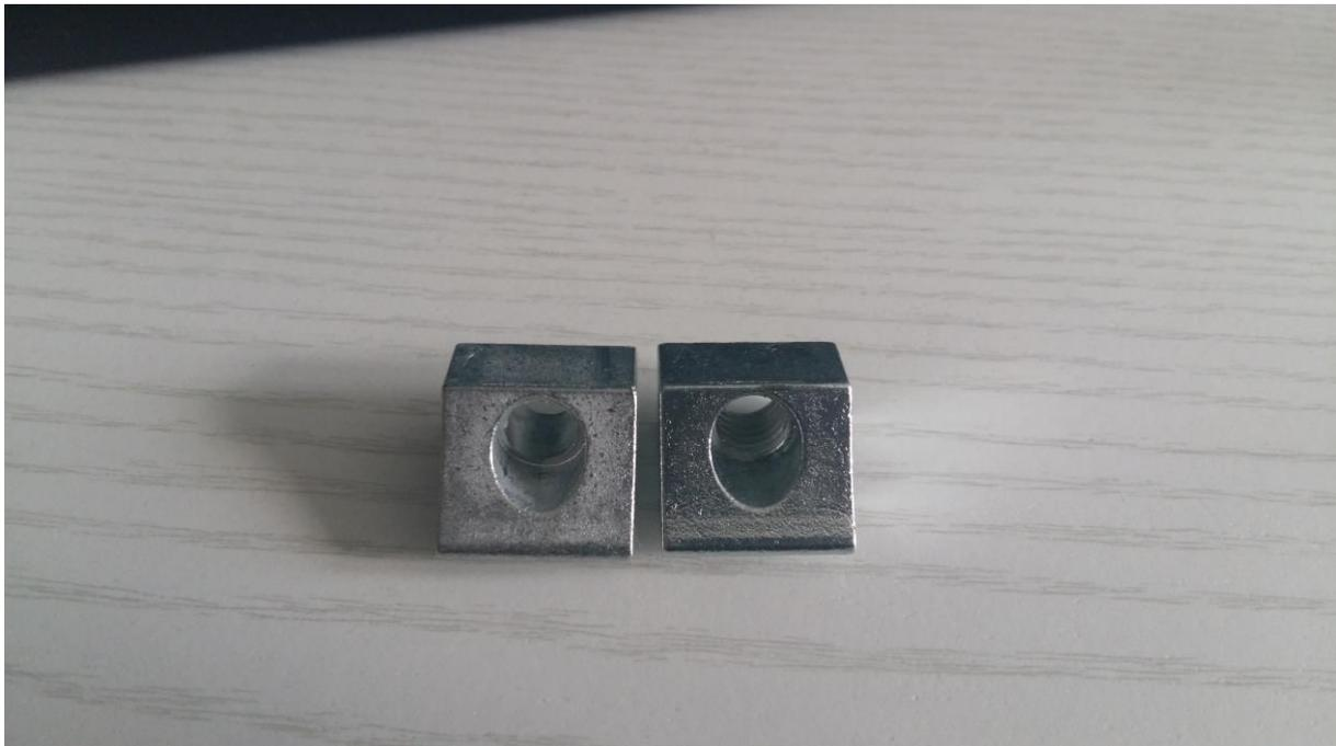
**Slika 12. Dio „A“: lijevo – tek odlijevan; desno – nakon svih obrada**
