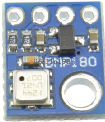
Slika 41 BMP180, barometar
