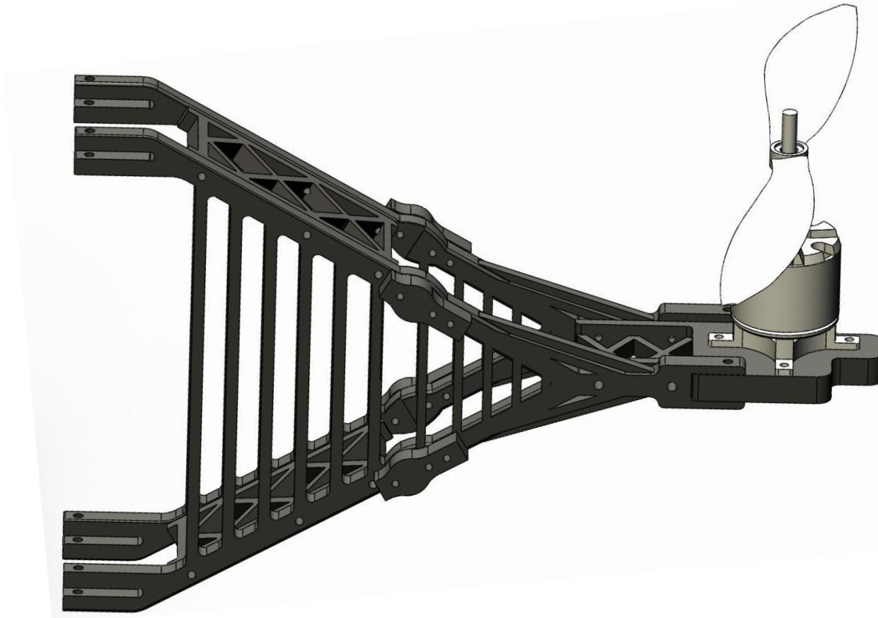
**Slika 18** Sklop nosača motora
