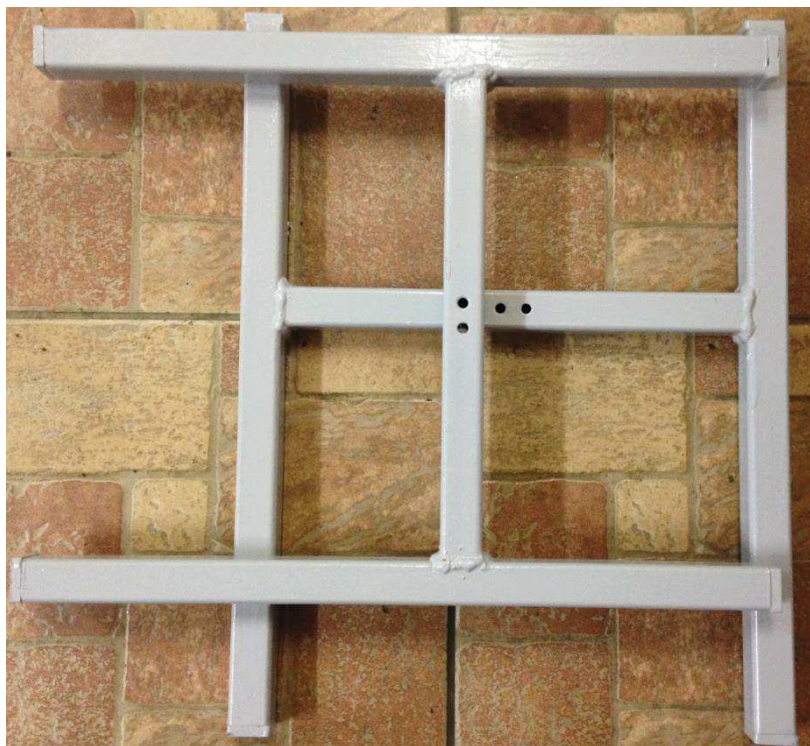
Slika 23. Završna slika zaštite konstrukcije
