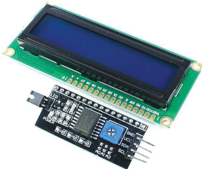
Slika 17. LCD 1602 i I2C modul [16]
