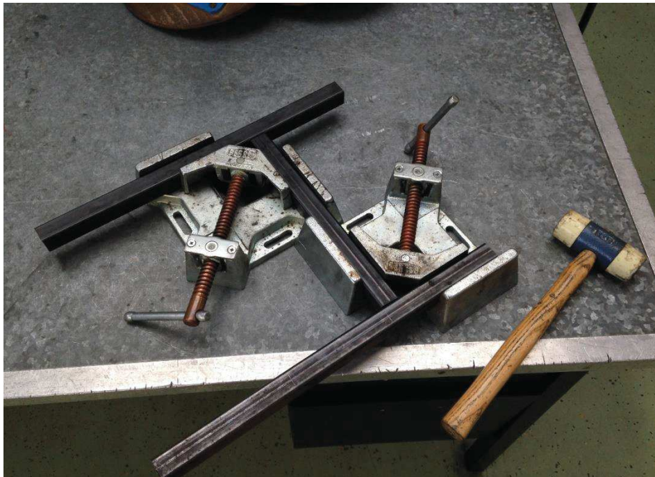
Slika 19. Postavljanje profila u kutni škrip i stezanje
