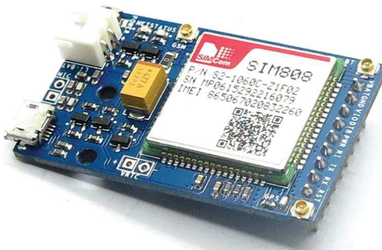
Slika 13. SIM808 GSM, GPS, Bluetooth modul [14]
