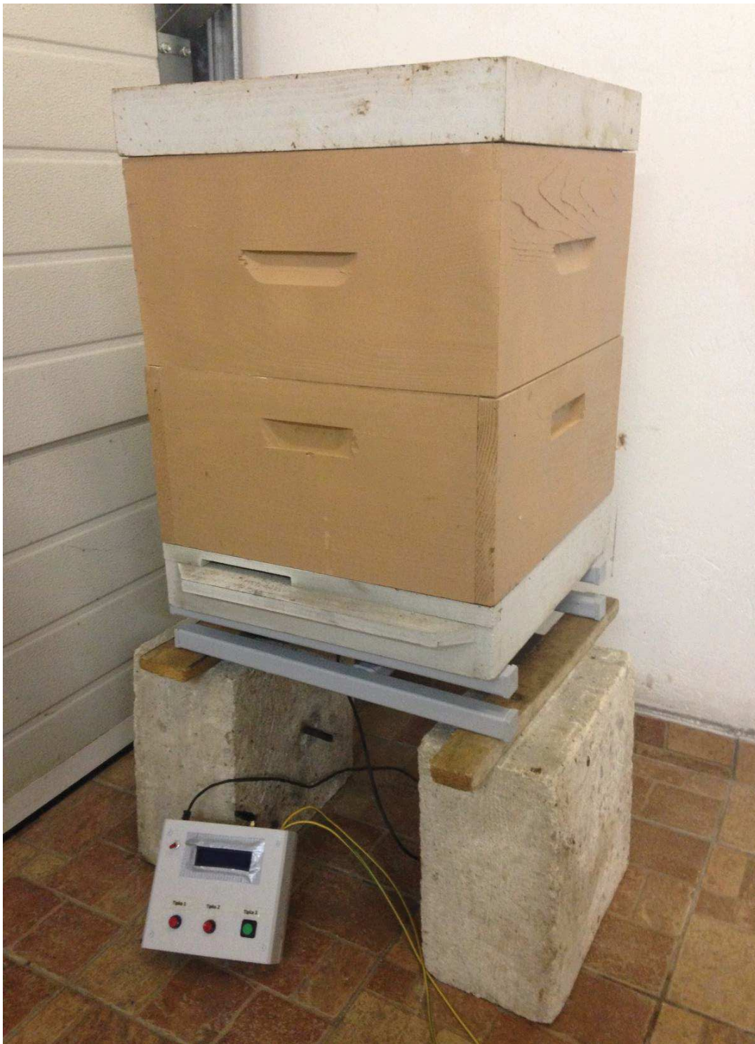
Slika 2. Sustav elektroničke vage za mjerenje mase košnice
