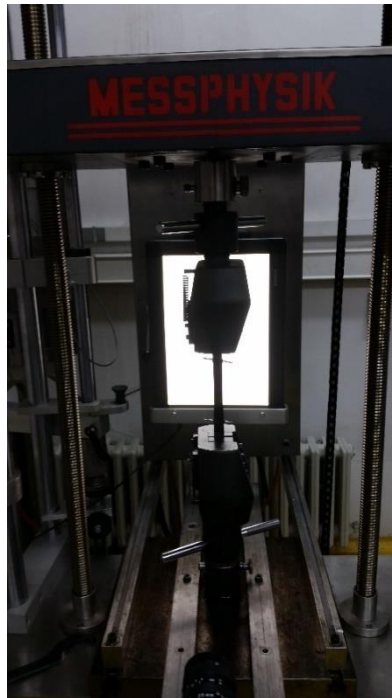
Slika 15. Kidalica MESSPHYSIK BETA
