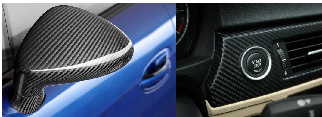
Slika 5. Vidljivi slojevi ugljičnih vlakana [5]
