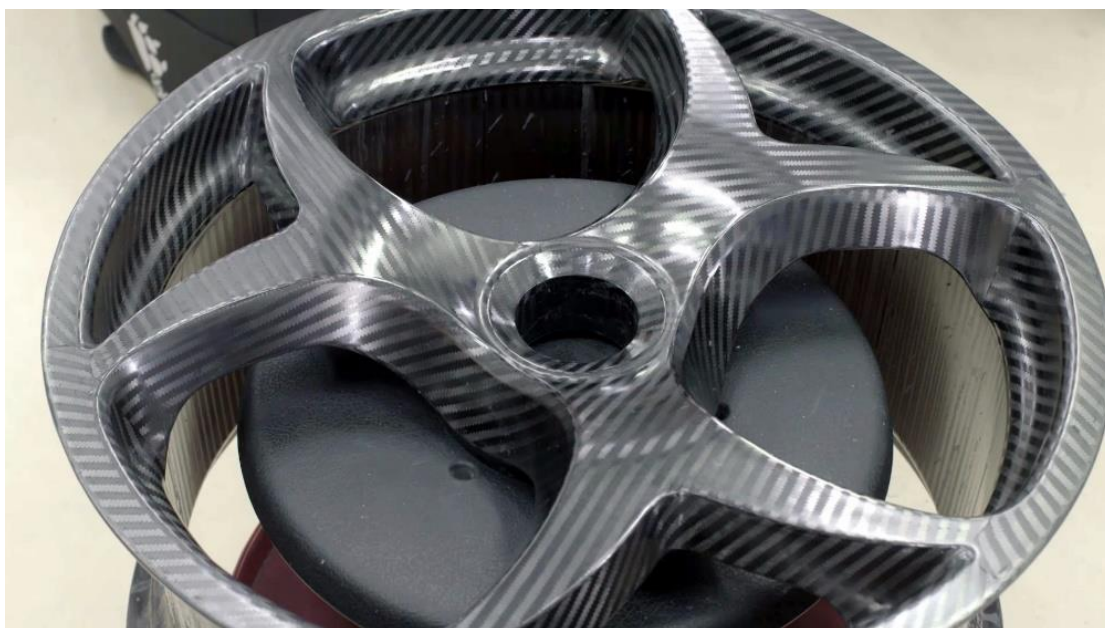
Slika 6. Kotač od kompozita s ugljičnim vlaknima Koenigsegg Regera [10]
