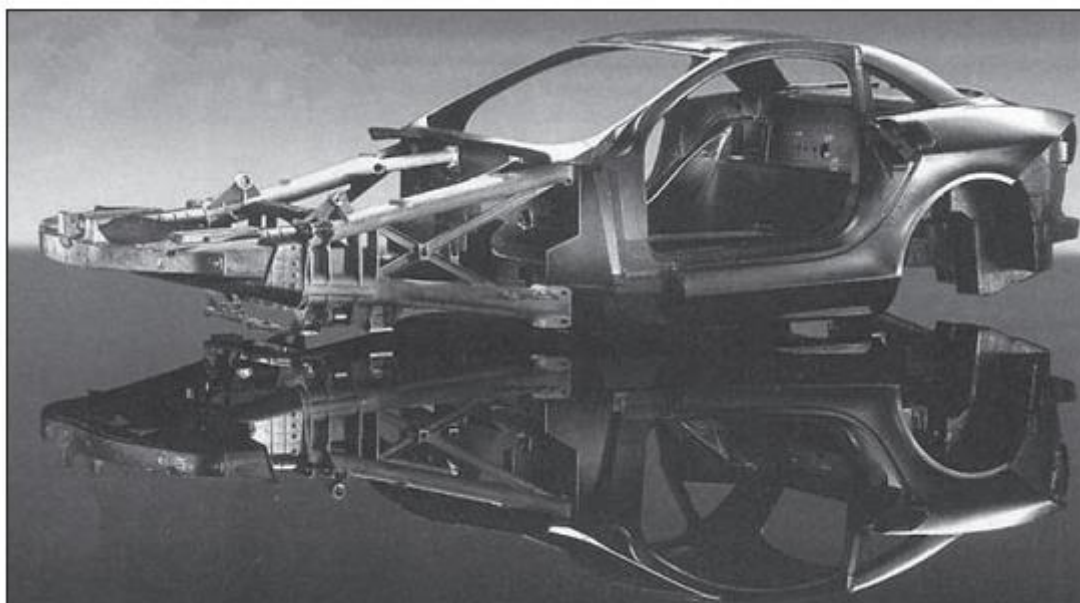
Slika 2. Prednja sudarna konstrukcija, ugljikom ojačan kompozit, Mercedes SLR [6]
