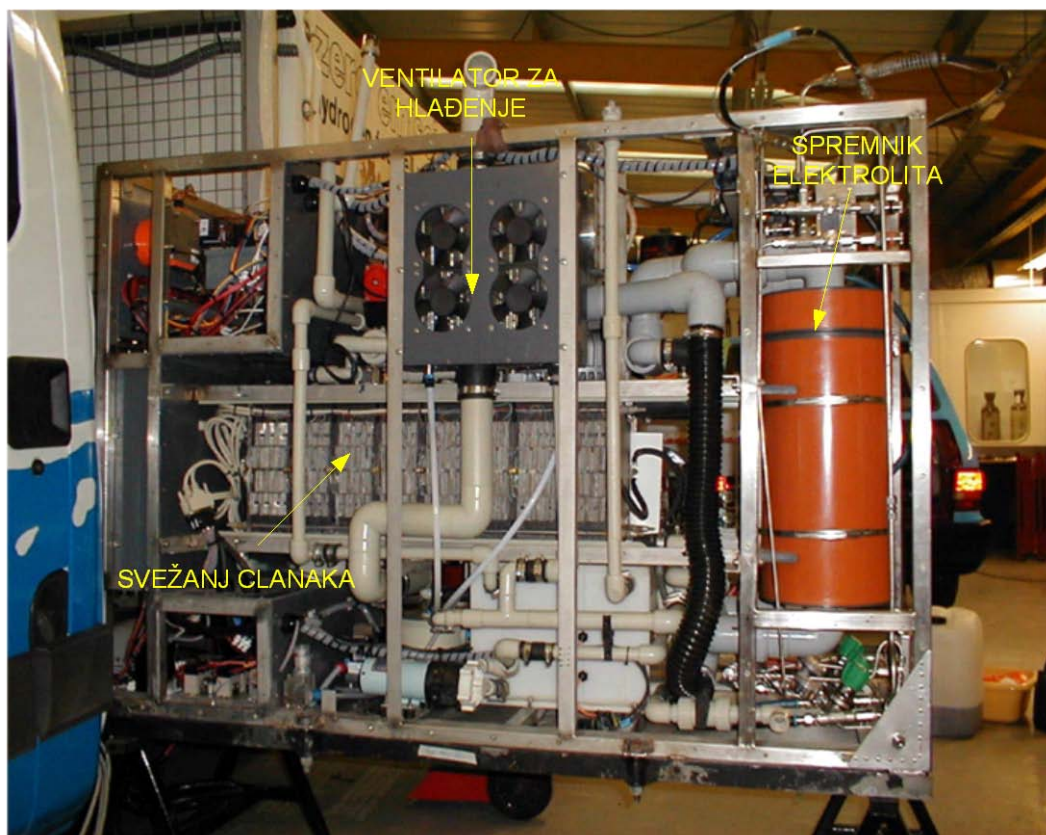
Slika 22. Prikaz realiziranog sustava (primjera 2) na vozilu
