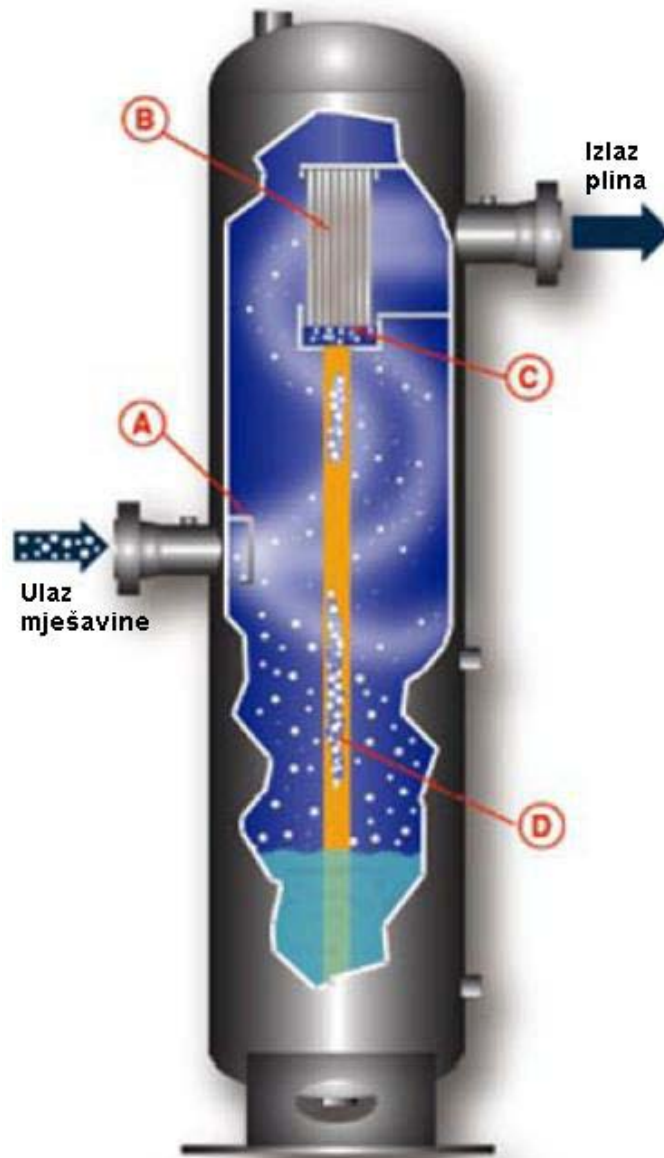
Slika 41 Vertikalni separator: a) ulazna barijera za odvajanje tekućine, b) filter za skupljanje čestica tekućine, c) lijevak za skupljanje tekućine d) cjevovod tekućine [14]
