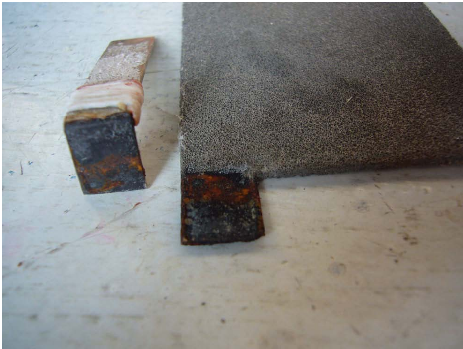
Slika 35. Korozija na spoju elektrode i kontaktne pločice
