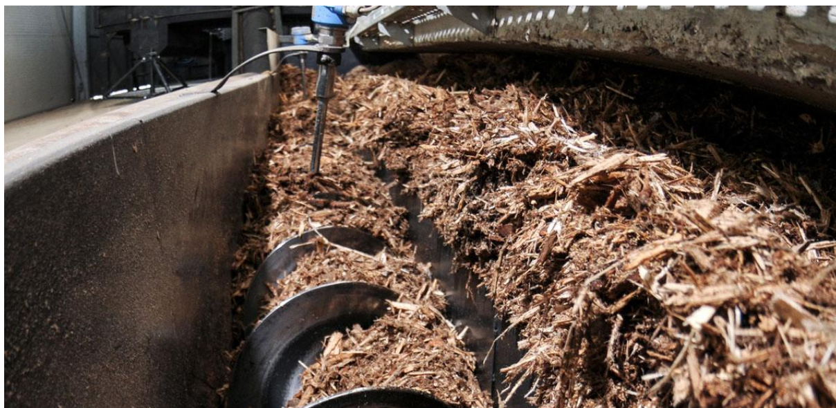
Slika 6. Prijenos biomase pužnim vijcima [7]
