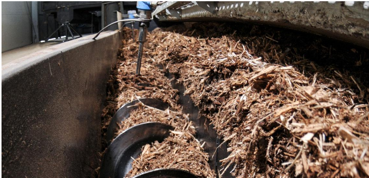
Slika 6. Prijenos biomase pužnim vijcima [7]
