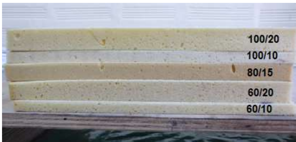
Slika 6.13. Poliuretanske pjene različitih gustoća i debljina upotrebljene u pokusu
