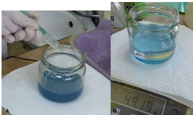
Slika 6.4. Priprema: a) poliesterske smole i umreživala, b) epoksidne smole i umreživala
