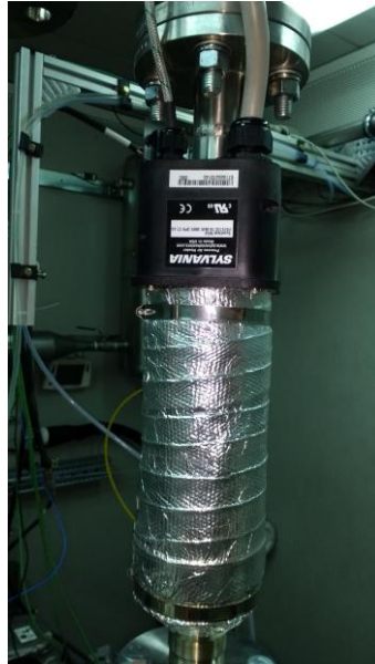
Slika 4.20 Grijač zraka Sylvania SureHeat Max
