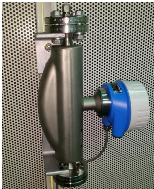
Slika 4.25 Mjerač protoka plinova, Coriolis
