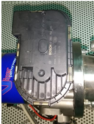
Slika 4.19 Zaklopka snage Bosch PBT GF30
