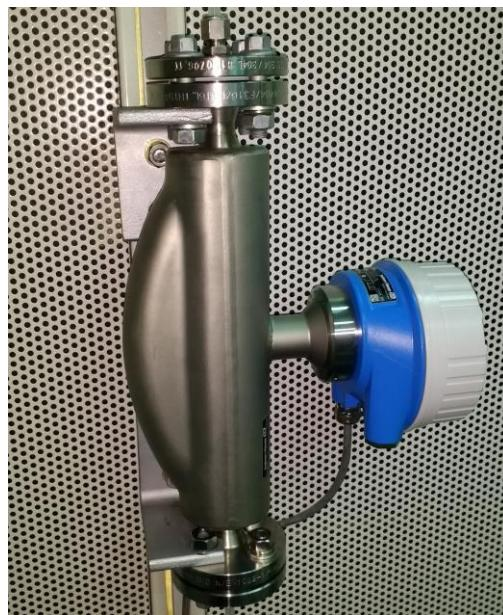
Slika 4.25 Mjerač protoka plinova, Coriolis
