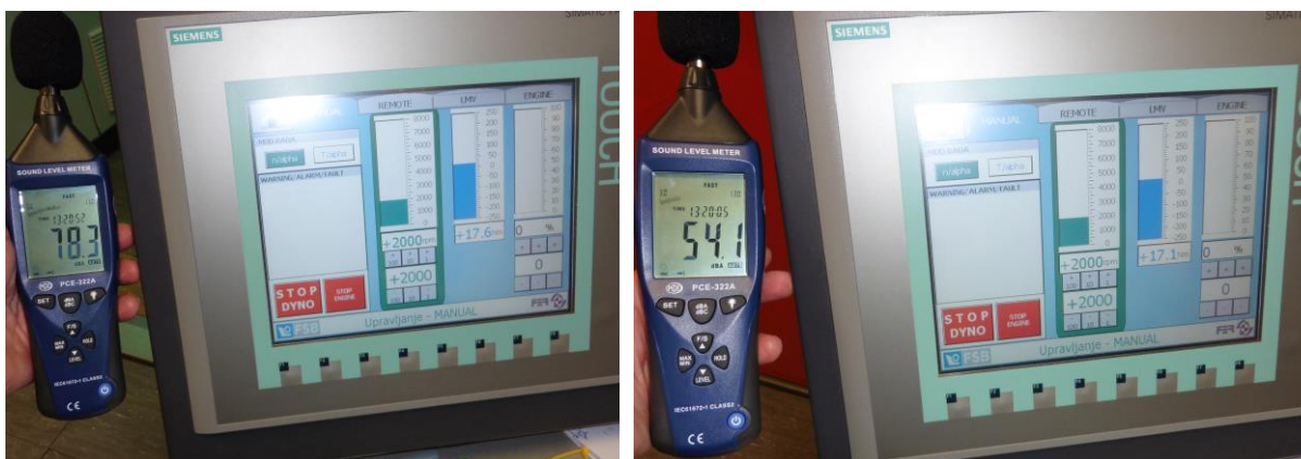
Slika 4.28 Razina buke u kontrolnoj sobi pri radu MSUI na 2000 \text{ min}^{-1} s otvorenim vratima (lijevo) i sa zatvorenim (desno)
