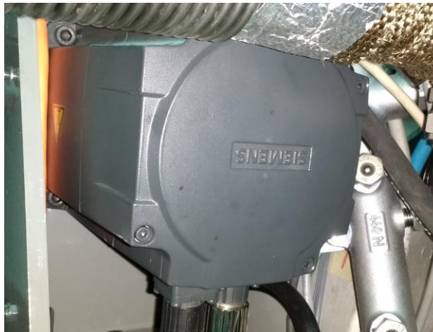
Slika 4.26 Elektromotor pumpe goriva
