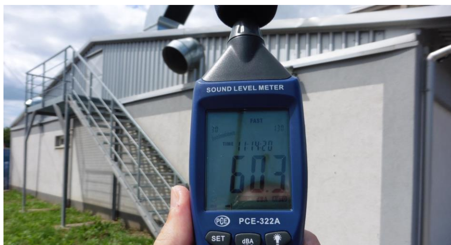
Slika 4.29 Razina buke u dvorištu LMV (istok – prema stambenim zgradama)
