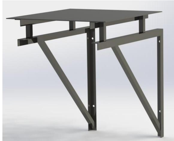
Slika 6.1 3D model nosača ventilacije
