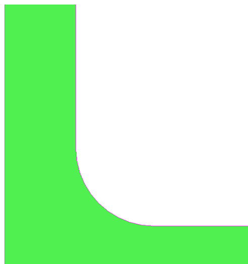
Slika 8. Detalj kuta otvora s radijusom zaobljenja r = 400 mm ( l/a = 1 )
