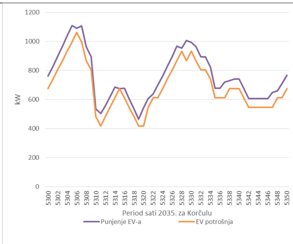
Slika 49 Period od 50 sati za Korčulu 2035. godine u umreženoj izvedbi, detaljan pogleda na ponašanje EV-a
