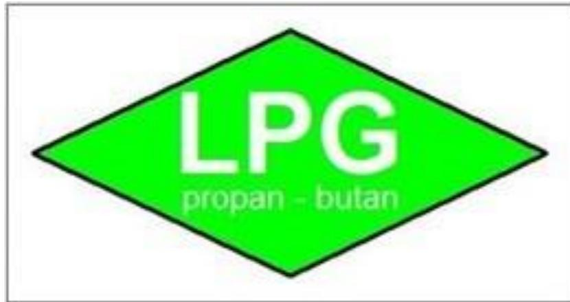
**Slika 2. Naljepnica za označavanje vozila s pogonom na UNP**
