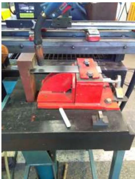
Slika 21. Postavljanje uzorka u steznu napravu
