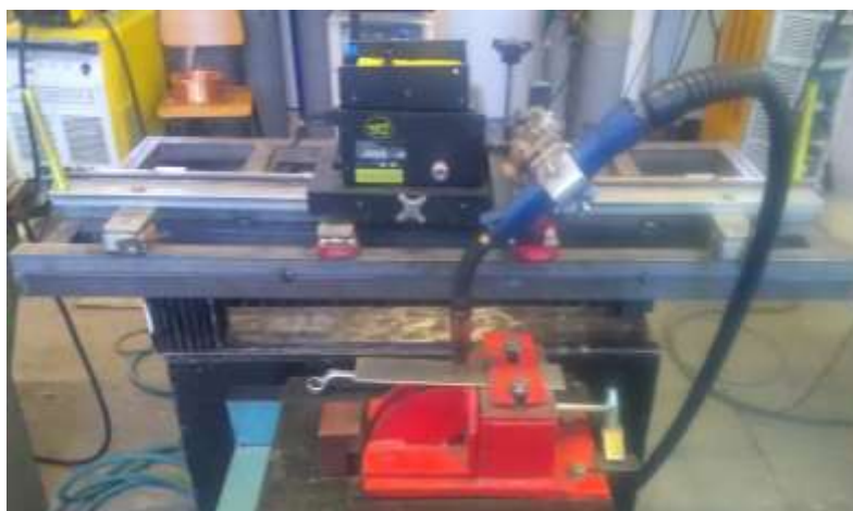
Slika 19. „Bug“ sustav za automatizaciju MIG/MAG zavarivanja
