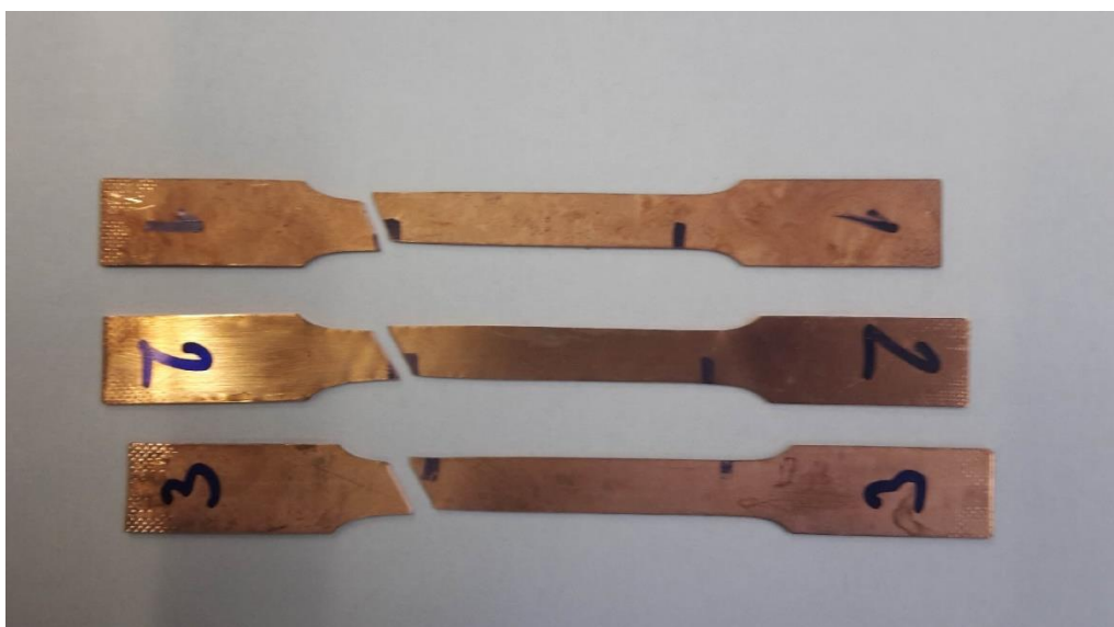
Slika 61. Uzorci čistog bakra očišćenog u \text{HNO}_3
