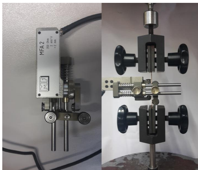
Slika 55. Ekstenziometar za mjerenje produljenja epruvete
