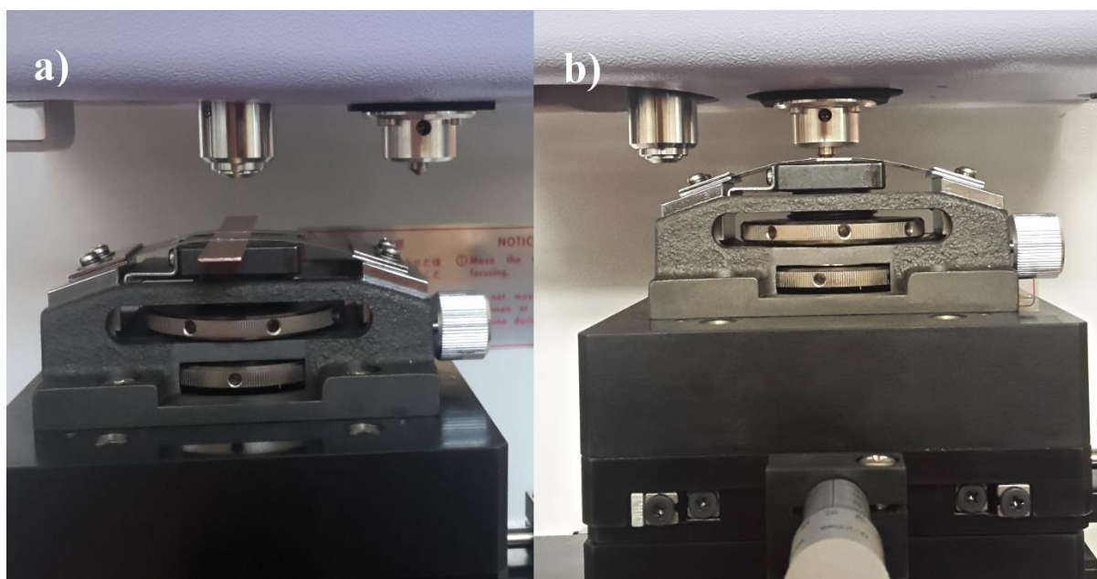
Slika 66. Uređaj za ispitivanje tvrdoće – a) kamera b) indentor
