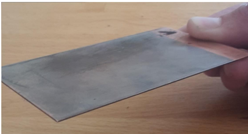
Slika 22. Pripremljena bakrena pločica za rezanje
