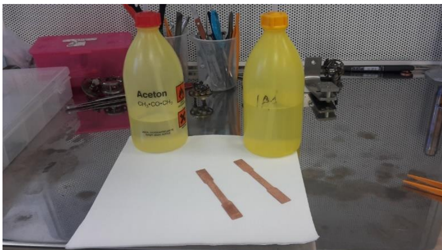
Slika 25. Uzorci nakon čišćenja acetonom i izopropilnim alkoholom
