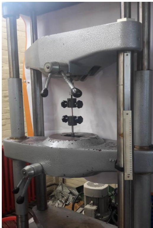
Slika 53. Univerzalna kidalica za statičko vlačno ispitivanje
