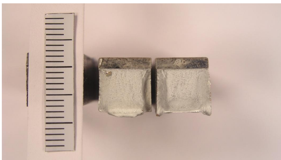
Slika 84. Prijelomna površina epruvete 13 / dozrijevano 4 h pri 160 °C
