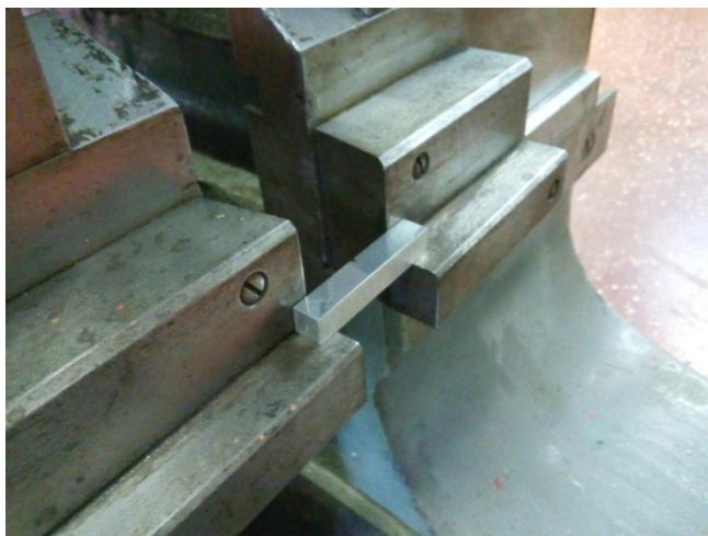
Slika 58. Položaj epruvete u osloncima
