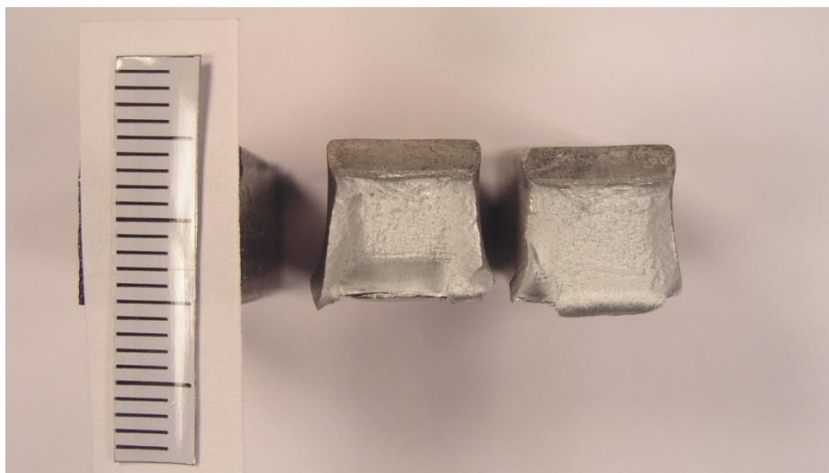
Slika 78. Prijelomna površina epruvete 30 / rastvorno žareno i gašeno u vodi
