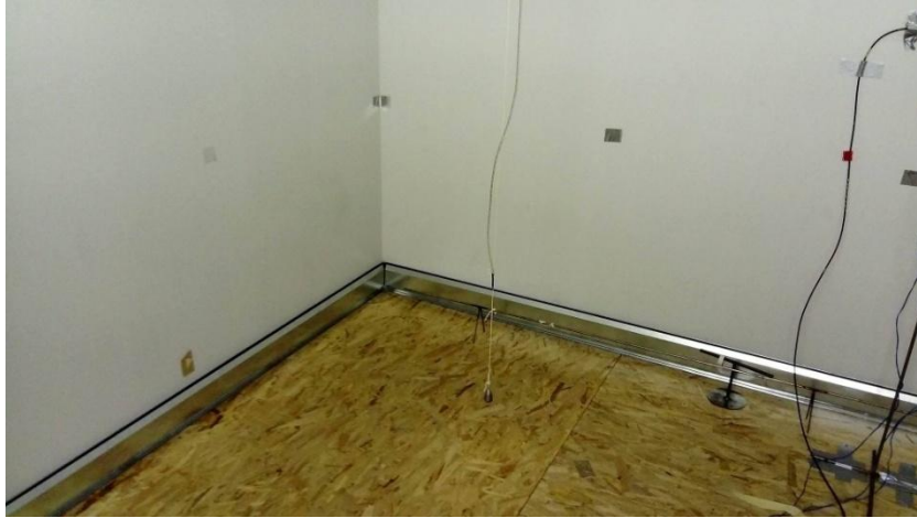
Slika 23 – Smještaj konvektora u ispitnoj prostoriji
