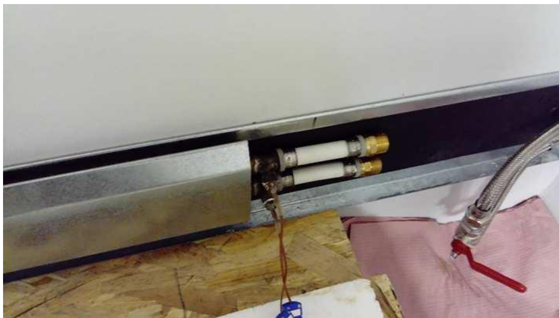
Slika 25 – Prikaz spajanja termoparova na polazni i povratni vod konvektora
