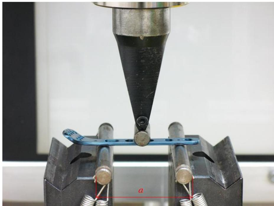
Slika 24 Eksperimentalni postav statičkog ispitivanja kratke pločice
