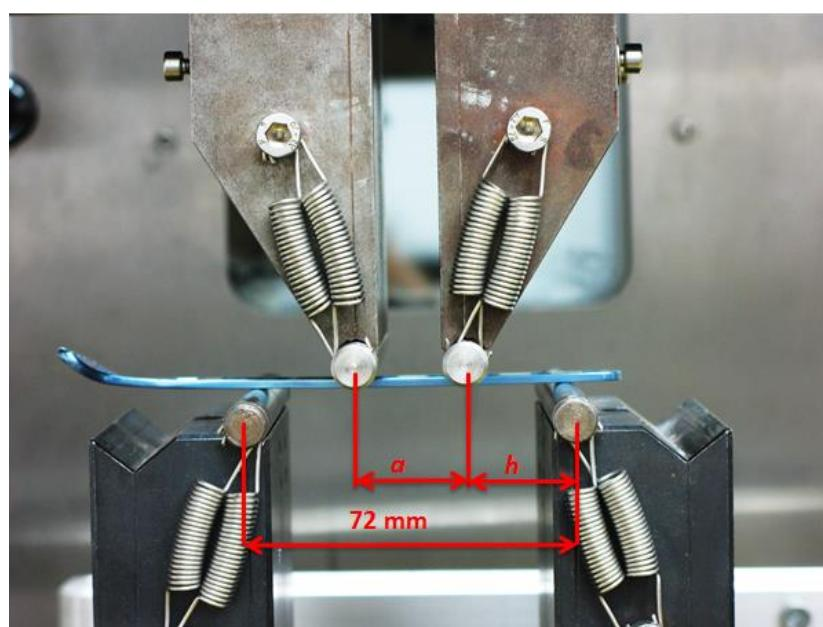
Slika 21 Eksperimentalni postav statičkog ispitivanja duge pločice
