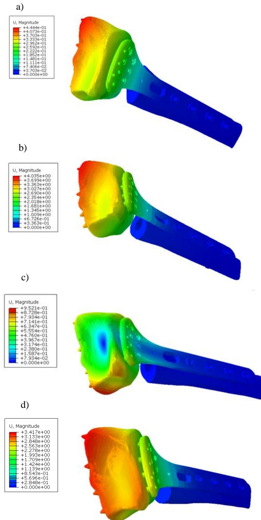
**Slika 29 Raspodjela pomaka na modelu s kratkom pločicom pri:** a) aksijalnom, b) dorzalnom, c) uvojnem i d) volarnom opterećenju
