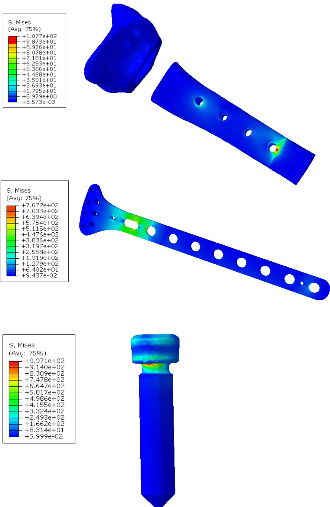
Slika 33 Raspodjela naprezanja na: a) kosti, b) vijka br.8 i c) pločice pri dorzalnom savijanju
