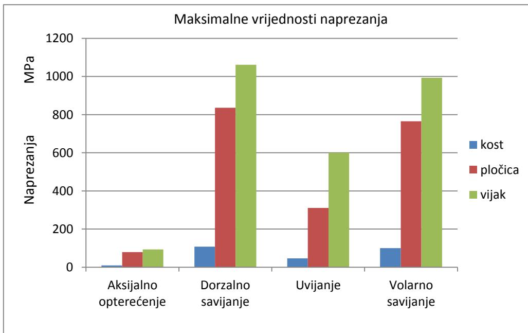
Slika 35 Maksimalne vrijednosti naprezanja modela s kratkom pločicom
