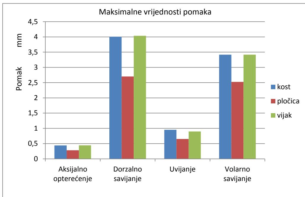
Slika 31 Maksimalne vrijednosti pomaka sustava s kratkom pločicom
