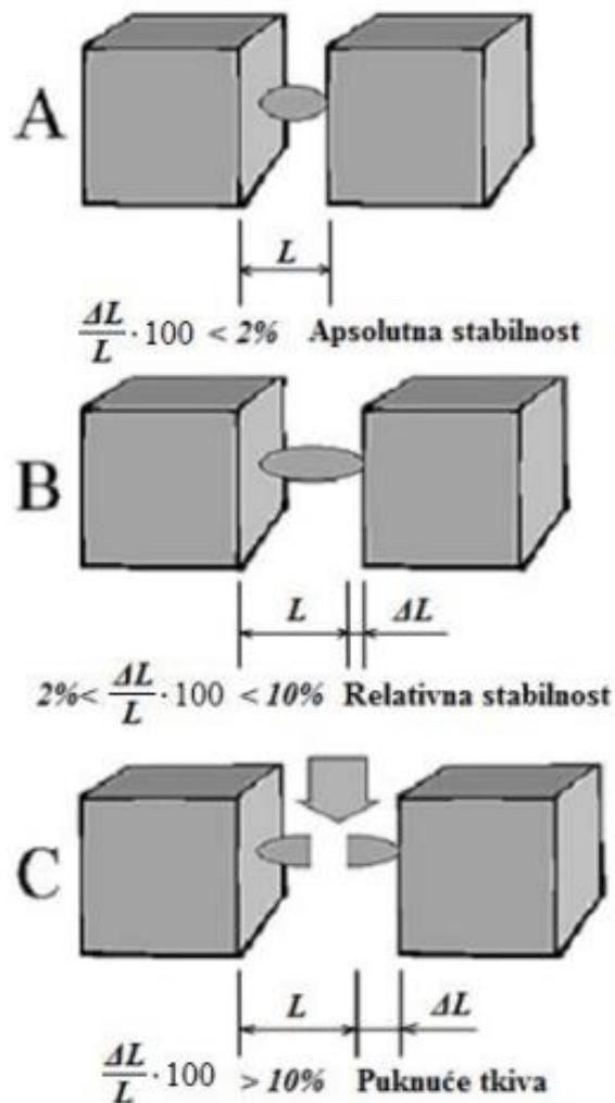
Slika 9 Biomehanička stabilnost pločice na zaključavanje [12]
