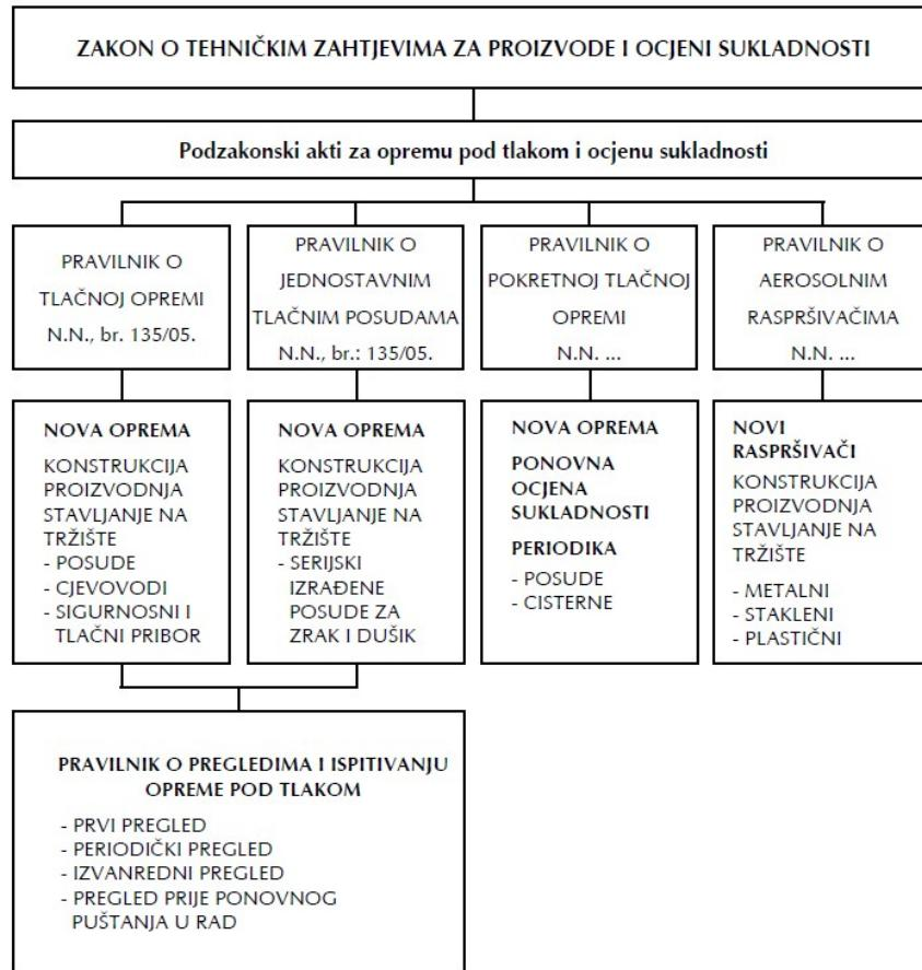
Slika 1: Struktura područja opreme pod tlakom [2]
