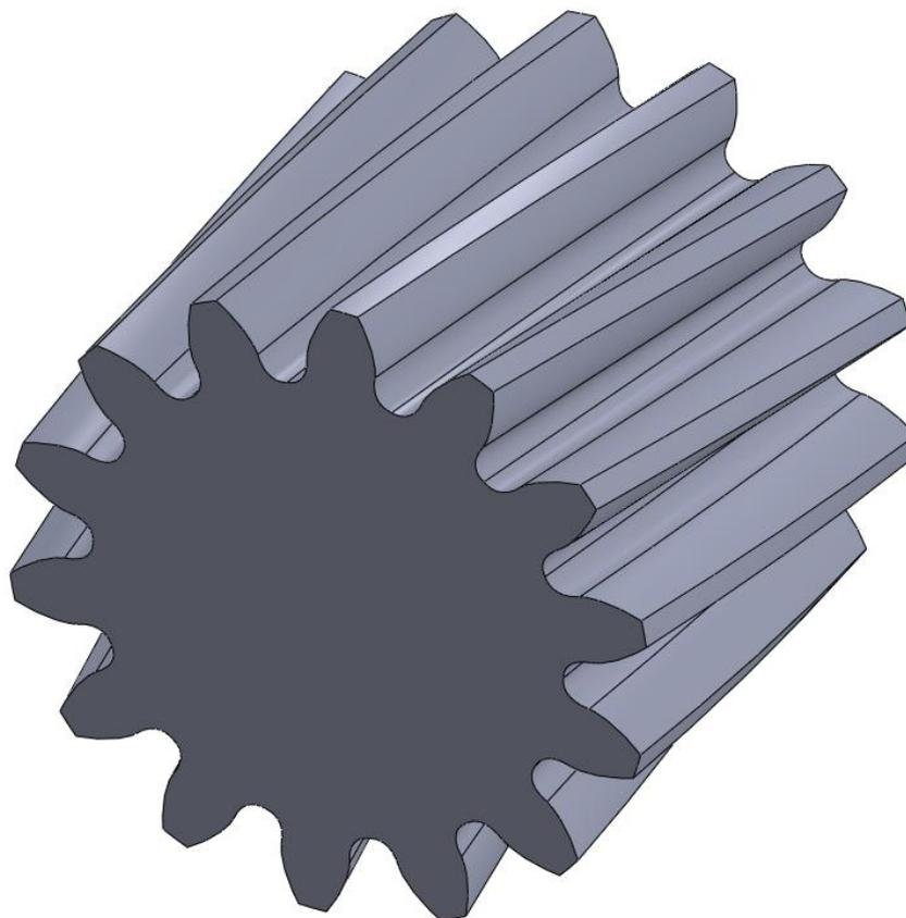
Slika 36. Zupčanik sa simetričnim kosim zubima
