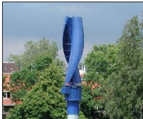
Slika 3.11. Spiralna Savoniusova vjetroturbin
