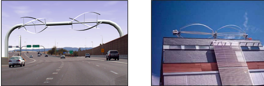
Slika 3.8. Horizontalne izvedbe Darrieusovih vjetroturbin
