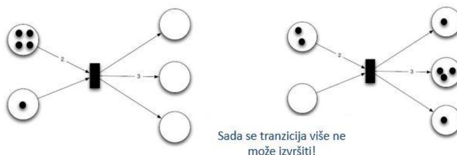
Slika 2: Uvjeti za izvršenje tranzicije su ispunjeni (lijevo), nisu ispunjeni (desno) [24]
