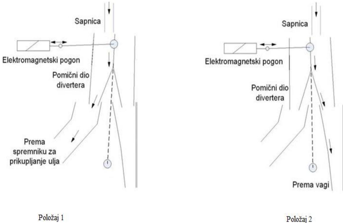
**Slika 14 Shema divertera u položaju strujanja ulja u spremnik za prikupljanje ulja i spremnik na vagi**
