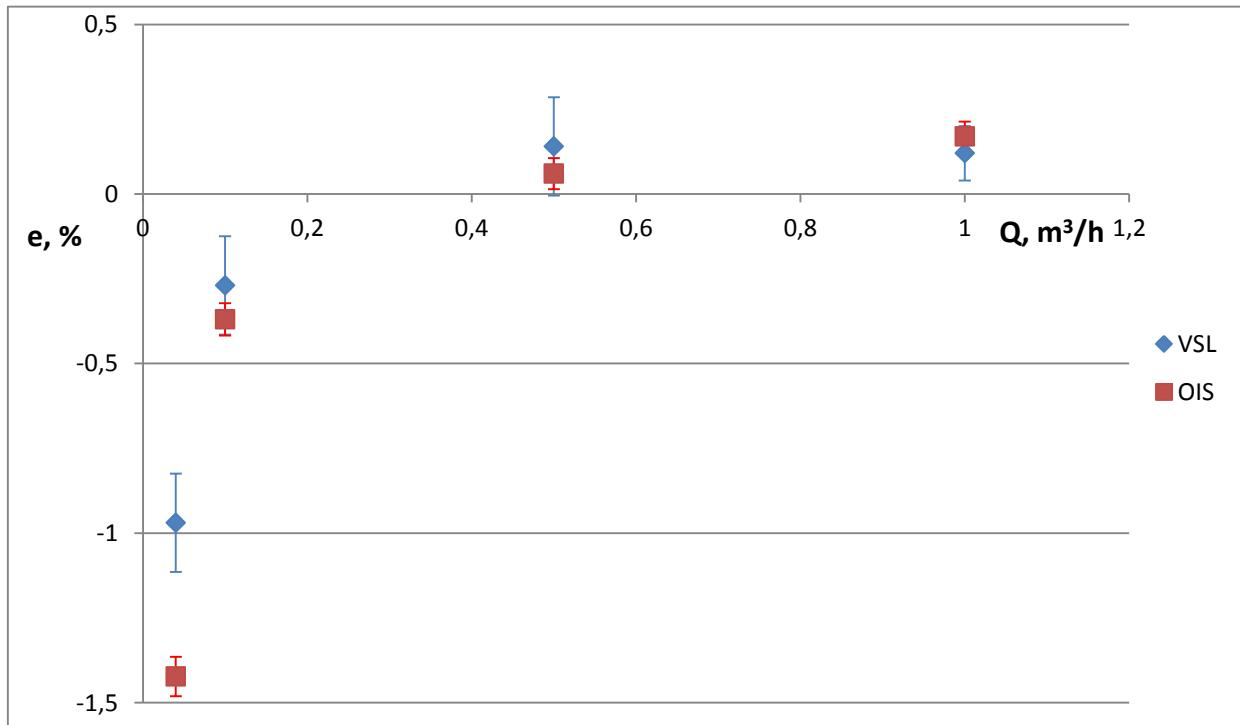
**Slika 24 Dijagram usporedba umjeravanja plinomjera IRMA G16 na Osnovnom ispitnom sustavi i na ispitnom sustavu VSL-a**
