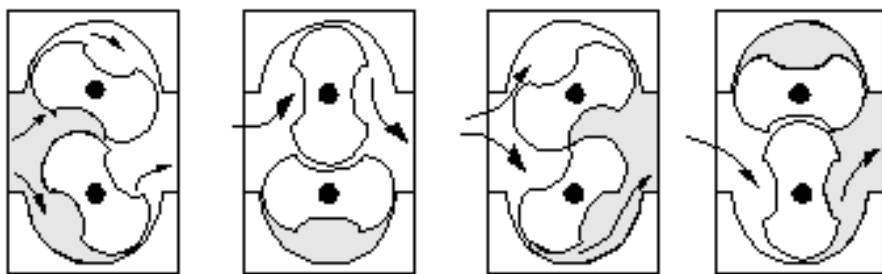
**Slika 9      Princip rada plinomjera s rotirajućim klipovima**
