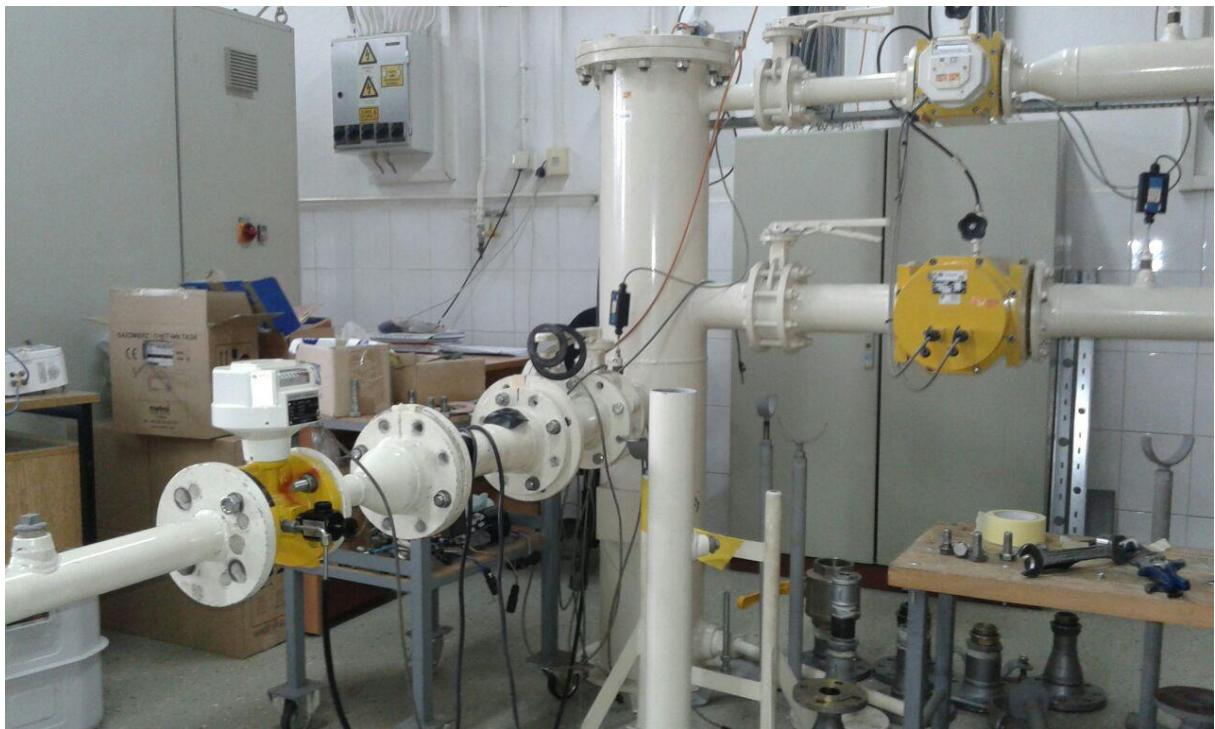
**Slika 19 Sustav za ispitivanje velikih protoka Gradske plinare Zagreb**
