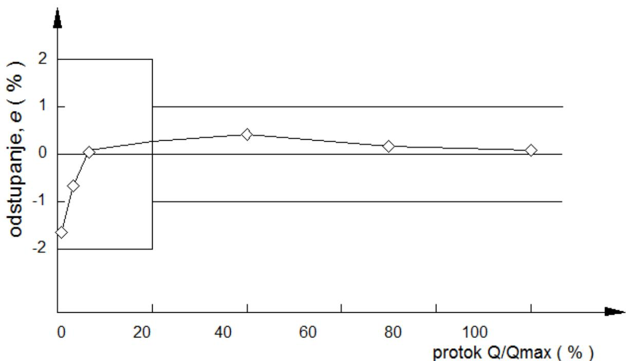
**Slika 10      Krivulja odstupanja plinomjera s rotirajućim klipovima**
