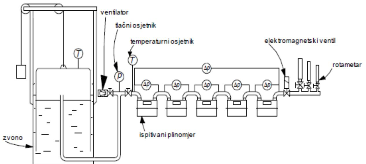
**Slika 16** Ispitna instalacija Sustava sa ispitnim zvonom
