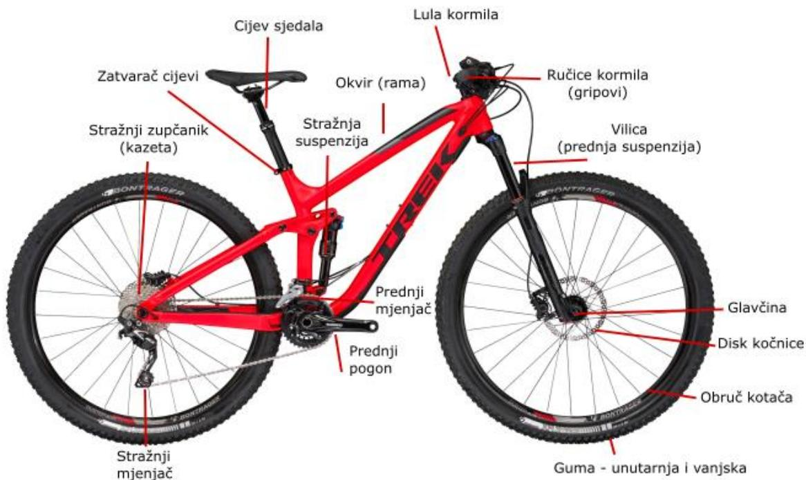
Slika 1. Dijelovi brdskog bicikla [6]
