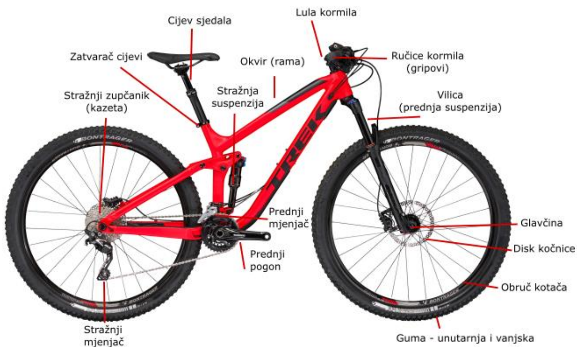
Slika 1. Dijelovi brdskog bicikla [6]
