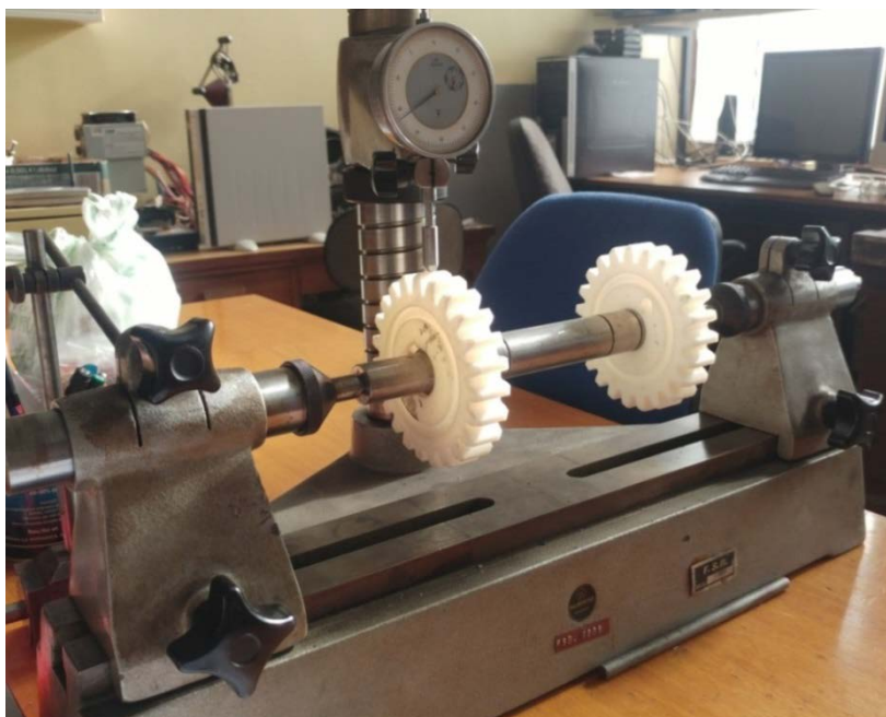
Slika 13 Mjerenje odstupanja vrtnje u radijalnom smjeru
