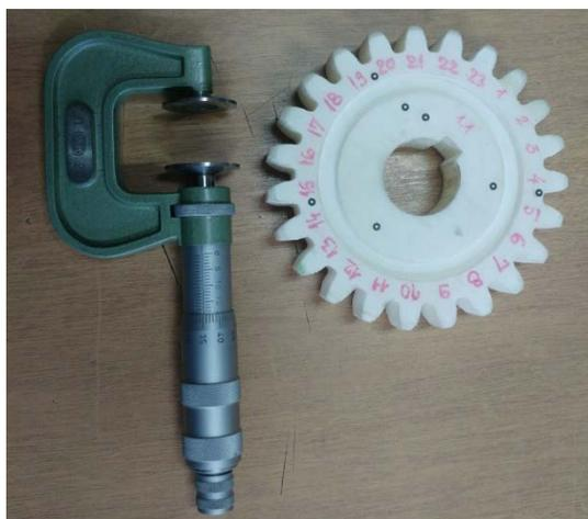
**Slika 16 Mikrometar za mjerenje mjere preko zubi**
