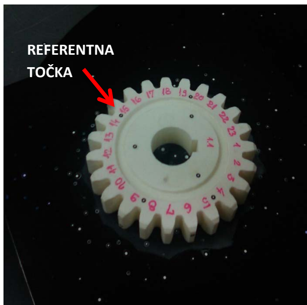
Slika 22 Referentne točke na podlozi i zupčaniku Z1.1
