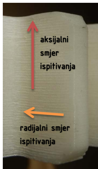
Slika 17 Smjerovi ispitivanja hrapavosti
