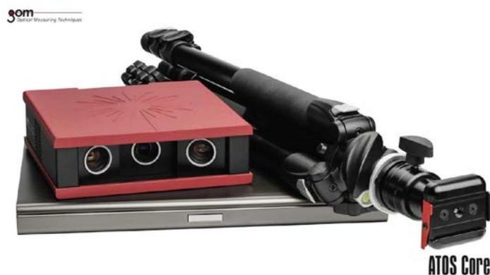
**Slika 2 3D digitalizator ATOS Core [9]**
