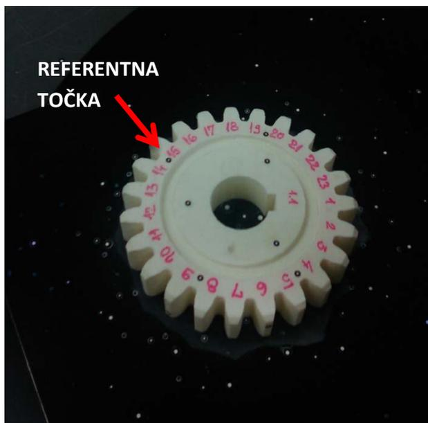
**Slika 22** Referentne točke na podlozi i zupčaniku Z1.1
