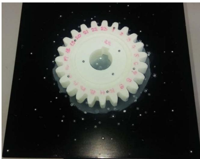
**Slika 23** Zupčanic 1.2 sa slojem titanovog oksida
