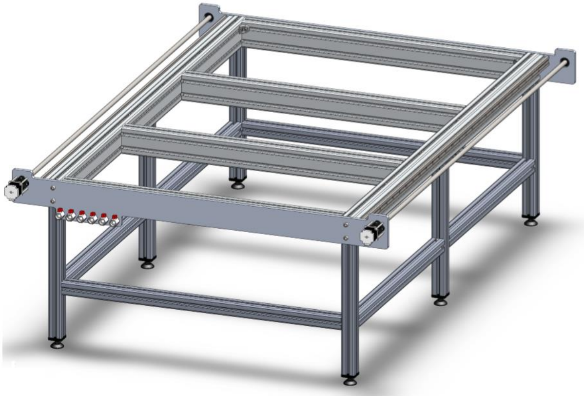
Slika 62 Izvedba konstrukcije X osi
