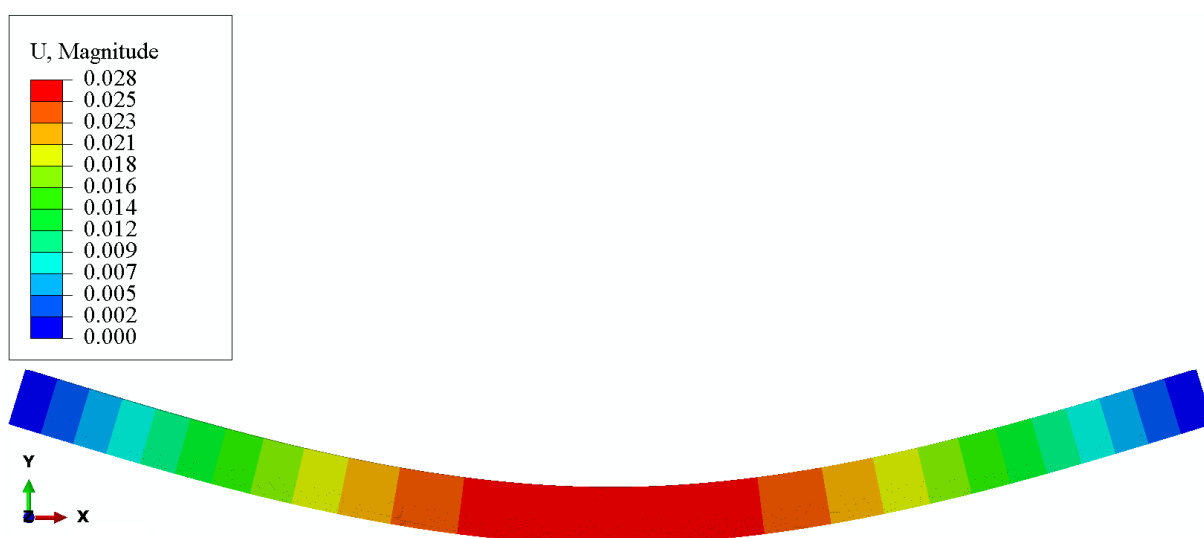
Slika 74. Progib glavnog nosača mosta
