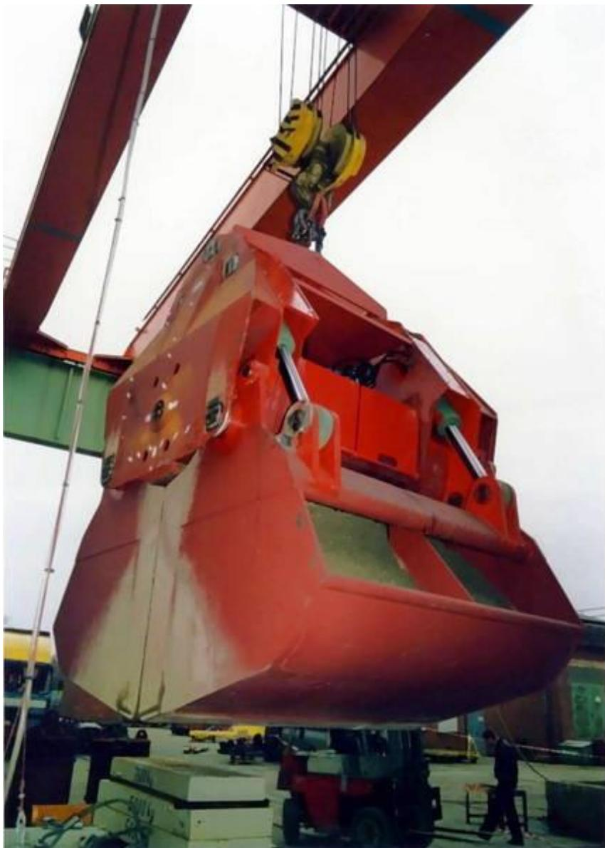
Slika 3. Hidraulična trim grabilica [4]
