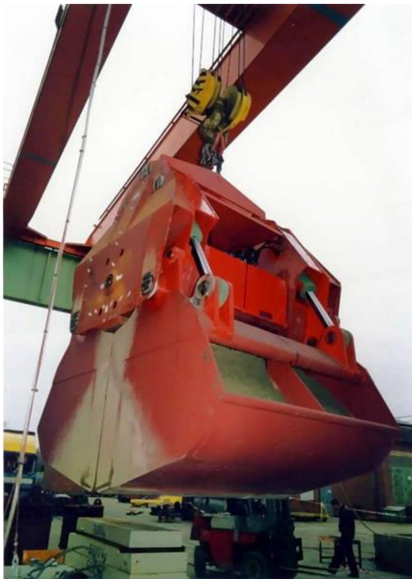
Slika 3. Hidraulična trim grabilica [4]
