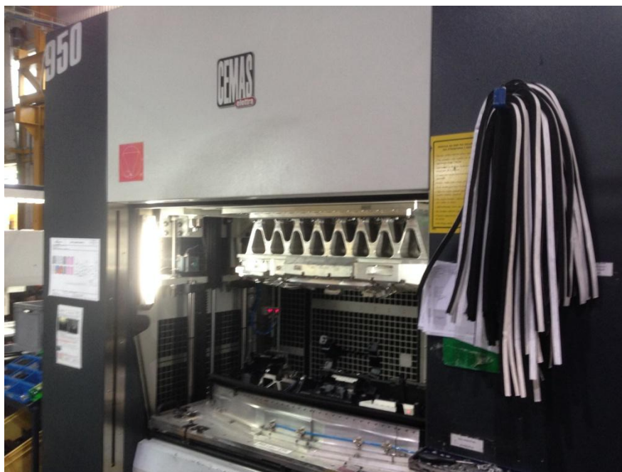
Slika 38. Stroj za vibracijsko zavarivanje „CEMAS 950“
