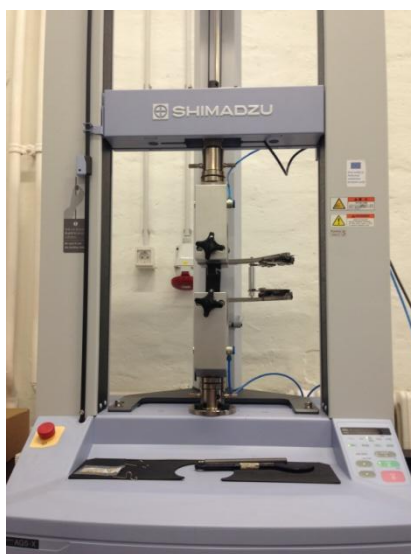
Slika 52. Kidalica za ispitivanje smične čvrstoće „Shimadzu“
