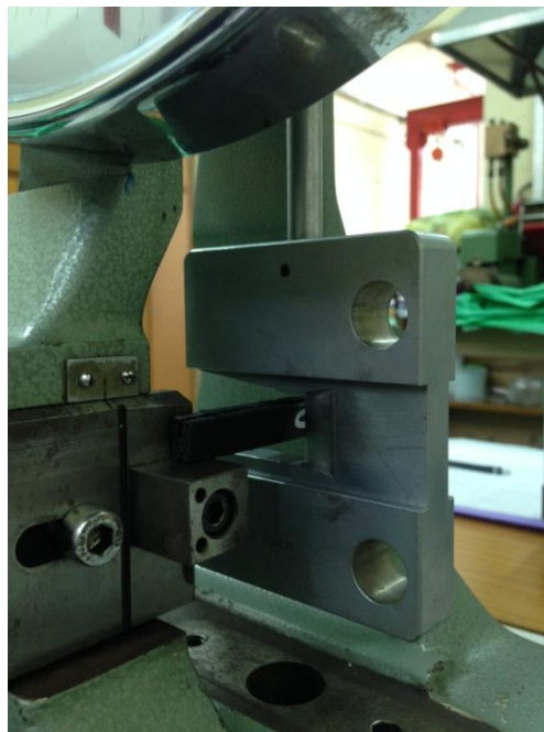
Slika 45. Epruveta postavljena na oslonac stroja
