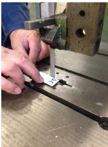
Slika 51. Izrada epruvete za ispitivanje smične čvrstoće
