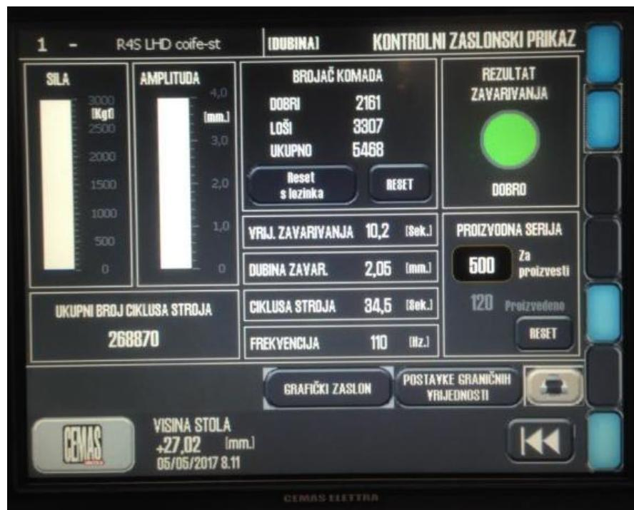
Slika 39. Parametri vibracijskog zavarivanja
