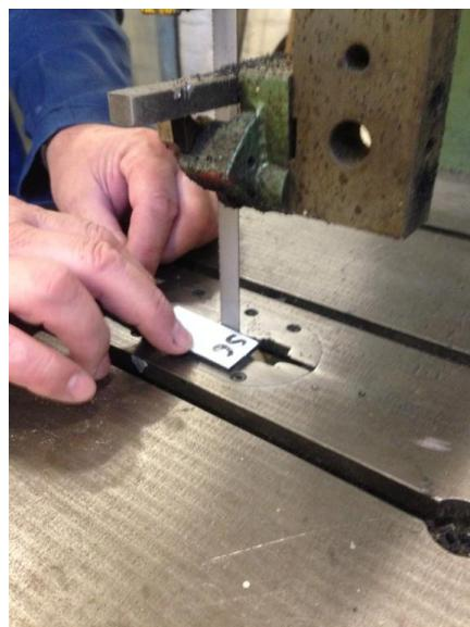
Slika 51. Izrada epruvete za ispitivanje smične čvrstoće
