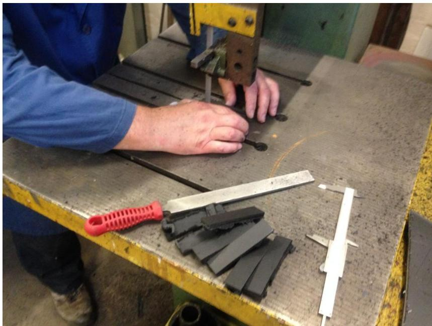
Slika 41. Fino rezanje i brušenje epruveta
