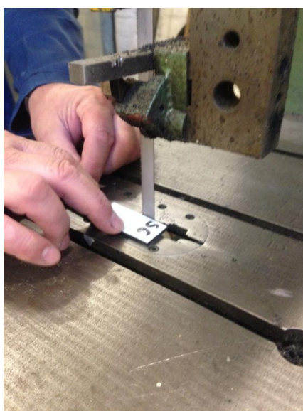
Slika 51. Izrada epruvete za ispitivanje smične čvrstoće
