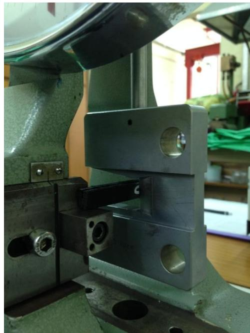
Slika 45. Epruveta postavljena na oslonac stroja
