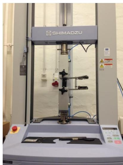
Slika 52. Kidalica za ispitivanje smične čvrstoće „Shimadzu“
