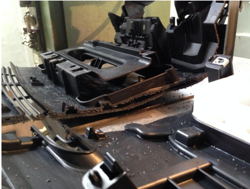
Slika 40. Grubo rezanje unutrašnje konzole automobila
