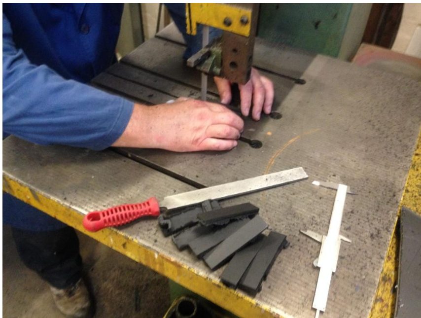
Slika 41. Fino rezanje i brušenje epruveta
