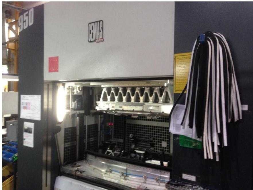
Slika 38. Stroj za vibracijsko zavarivanje „CEMAS 950“
