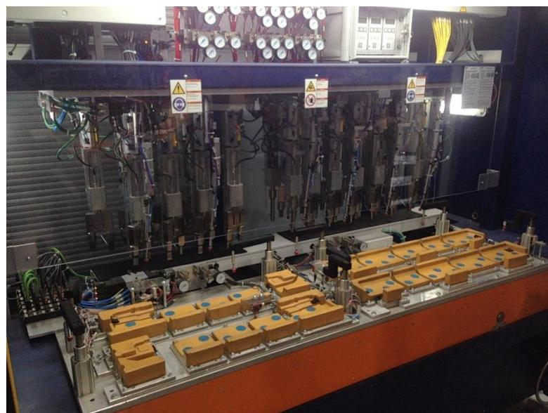
Slika 48. Stroj za ultrazvučno zavarivanje
