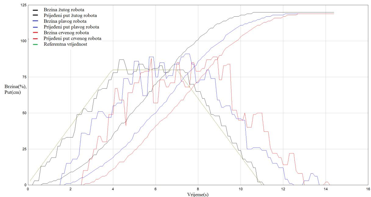
**Slika 35.** Distribuirano upravljanje kolonom mobilnih robota s dvosmjernom regulacijom pogreške udaljenosti robota i regulacijom brzine s referentnom ulaznom vrijednošću izlaza regulatora prethodnika;  $f_2=b_2=3$ ,  $f_3=2,8$  i  $g_2=g_3=0,1$ .
