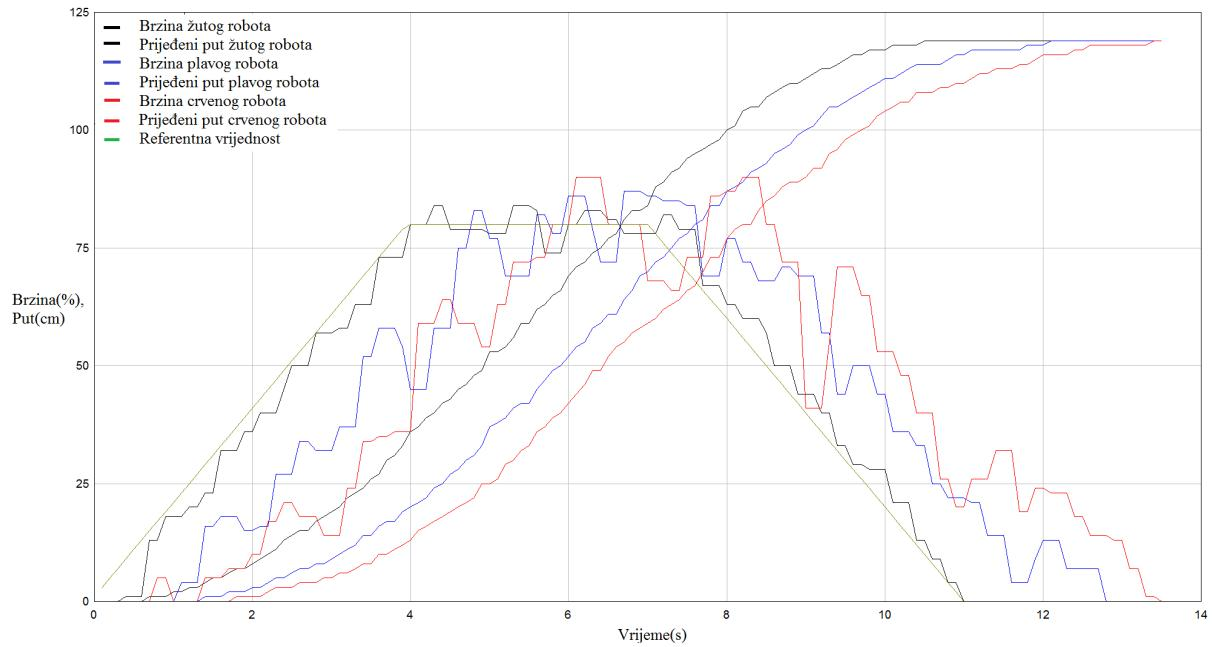
**Slika 31. Upravljanje kolonom mobilnih robota s lokalnom regulacijom absolutne pogreške brzine i udaljenosti do prethodnika**
