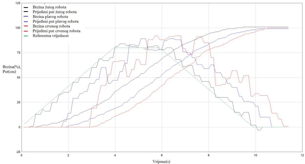
**Slika 20. Prikaz decentraliziranog upravljanja formacijom roboti s uključenim prednjim senzorom**
