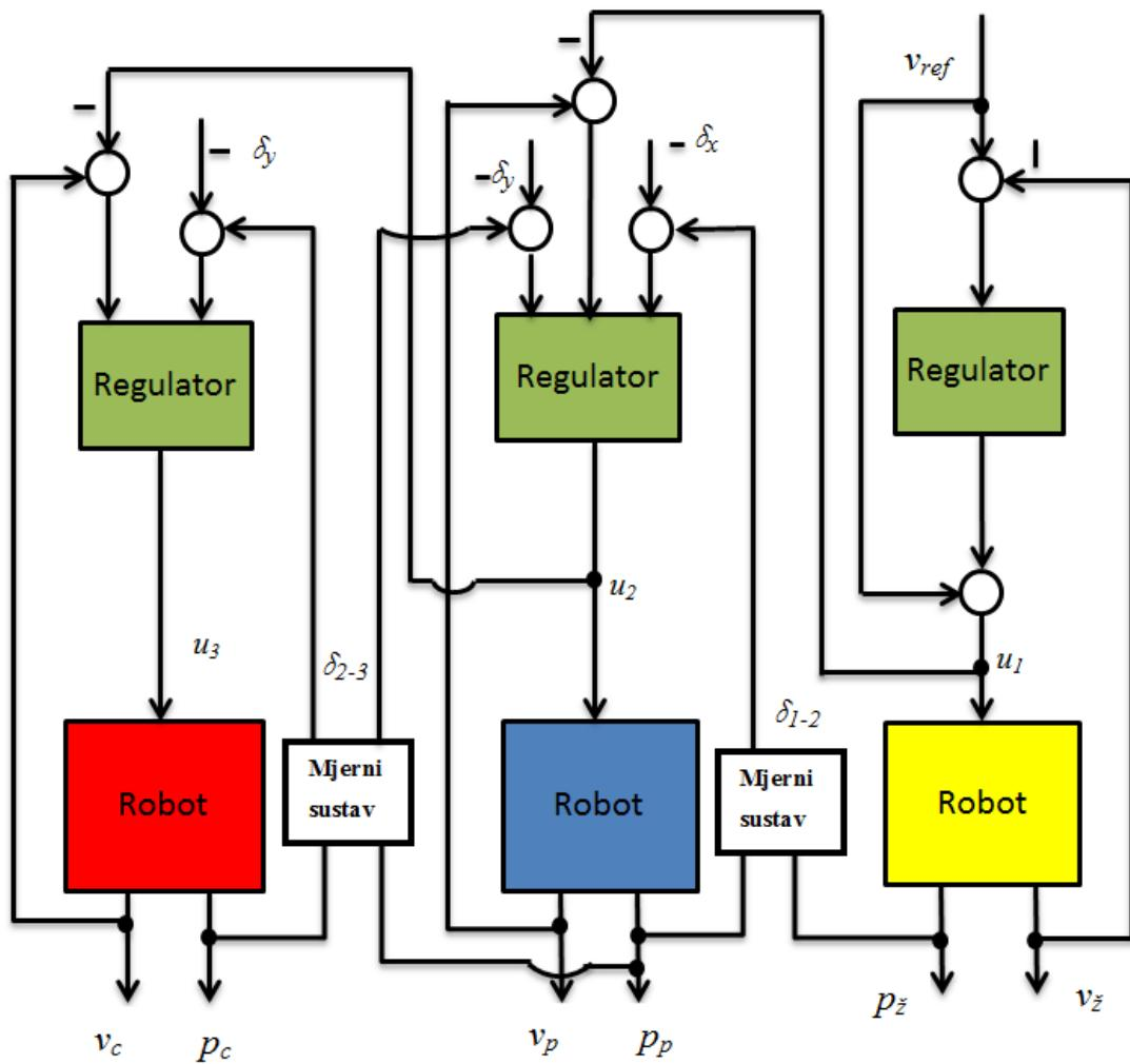
**Slika 33.** Decentralizirano upravljanje kolonom mobilnih robota s regulacijom razmaka između robota i vezom s reguliranim vrijednošću brzine prethodnika
