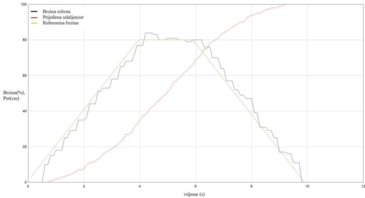
**Slika 18. Gibanje robota po trapezoidnom profilu brzine.**
