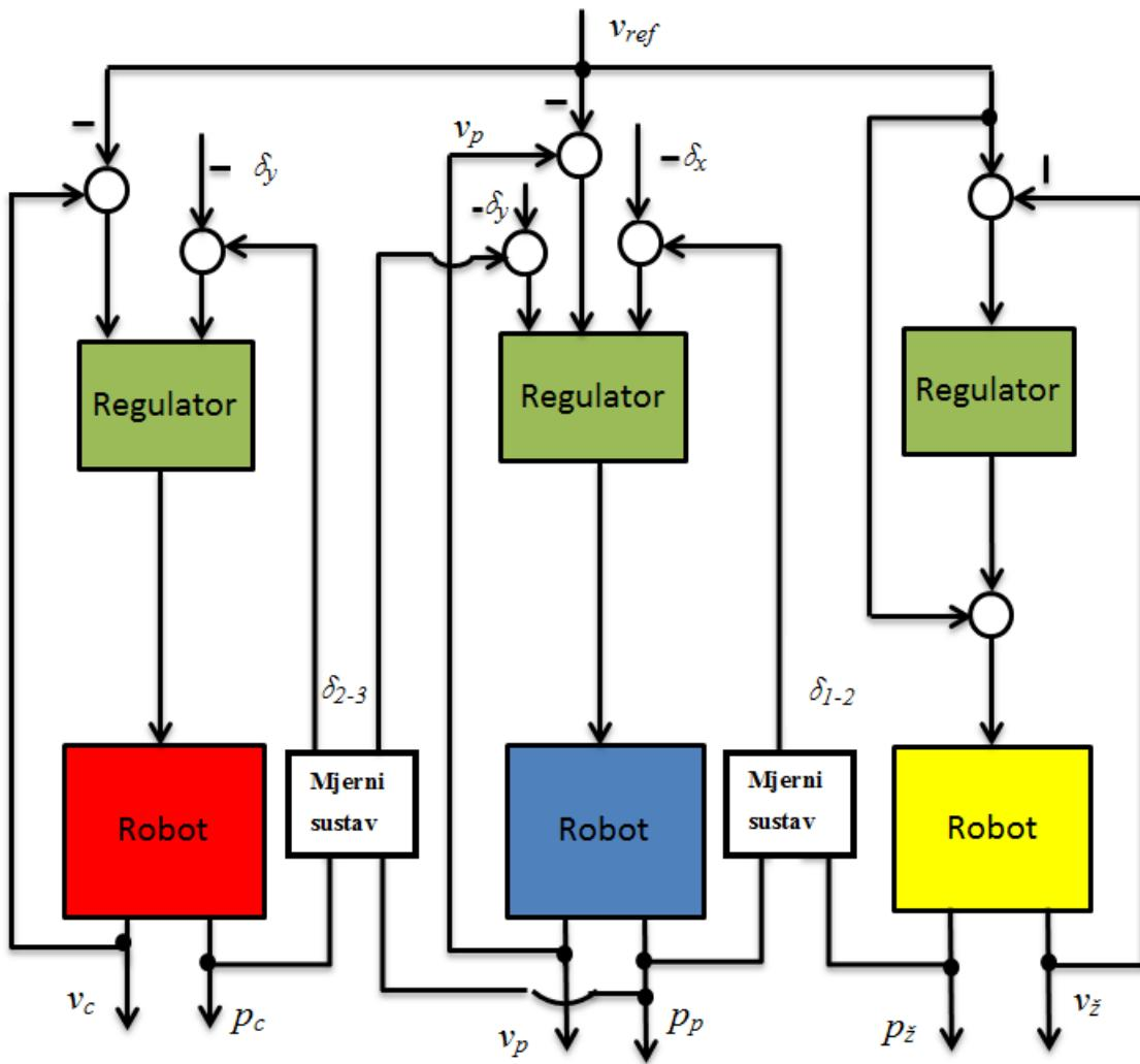
Slika 30. Struktura upravljanja formacije mobilnih robota, s regulacijom pogreške pozicije i absolutne pogreške brzine
