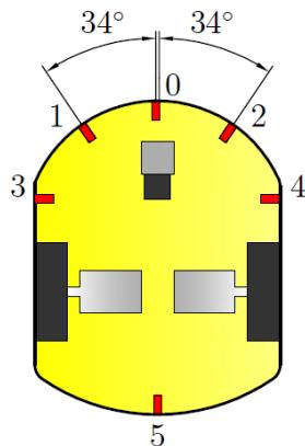
Slika 9. Mjerni sustav robota [1]
