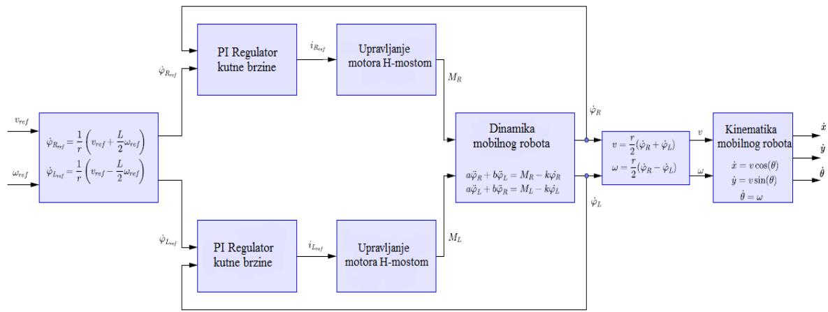
Slika 11. Struktura upravljanja diferencijalnog pogona mobilnog robota
