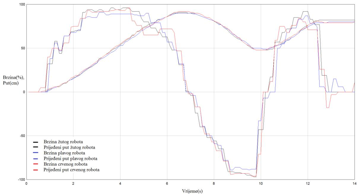
**Slika 24. Gibanje kolone mobilnih robota vođene joystickom**
