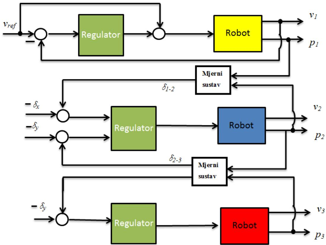
**Slika 19.** Struktura decentraliziranog upravljanja robota u koloni.
