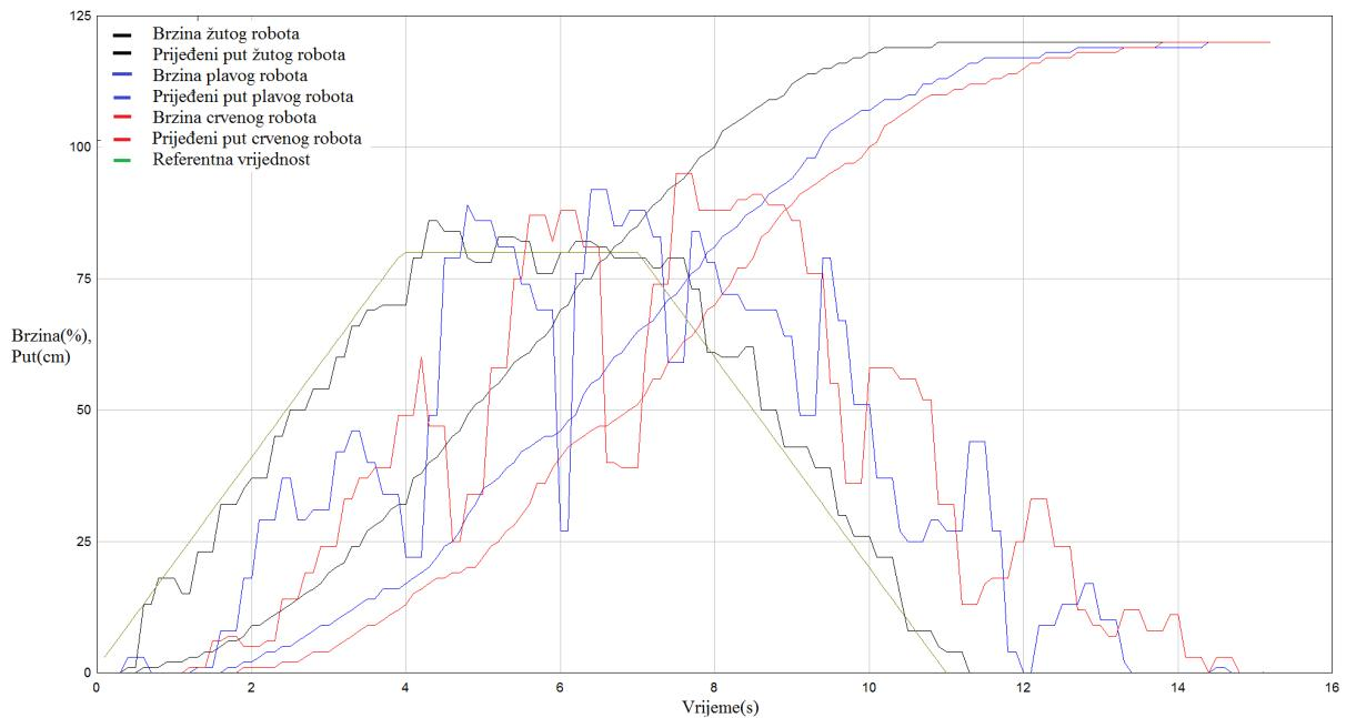
**Slika 32. Upravljanje kolonom mobilnih robota s lokalnom regulacijom absolutne pogreške brzine i udaljenosti do prethodnika i sljedbenika**
