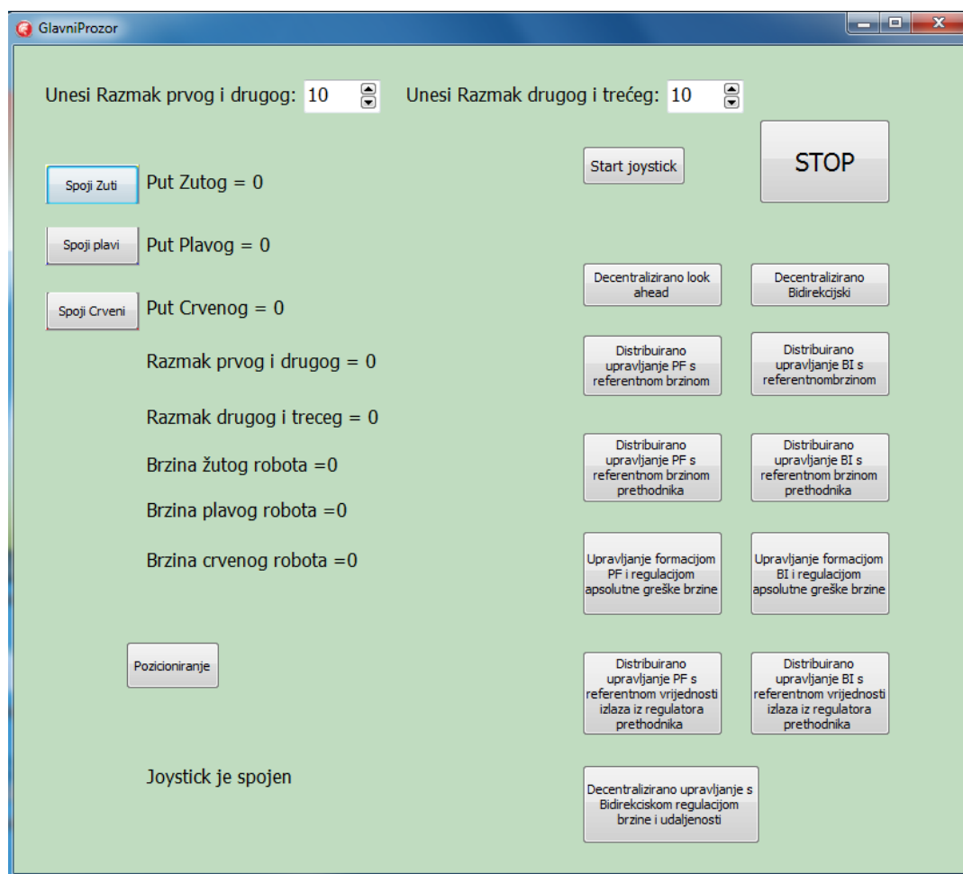
Slika 14. Programsko sučelje za gibanje 3 robota u koloni
