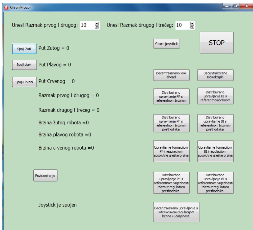
Slika 14. Programsko sučelje za gibanje 3 robota u koloni
