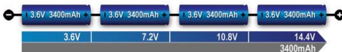
Slika 26. Serijski spoj baterijskih ćelija
