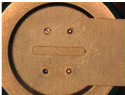
Slika 50. Micro TIG zavar spojnice i baterije
