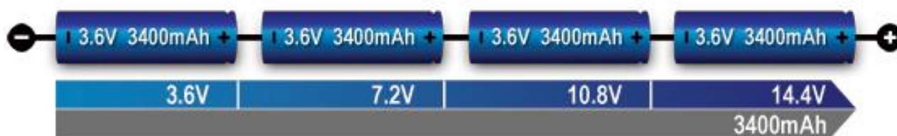
Slika 33. Serijski spoj baterijskih ćelija
