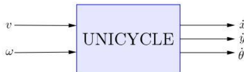
Slika 13. Ulazi i izlazi iz modela unicycle-a [14]
