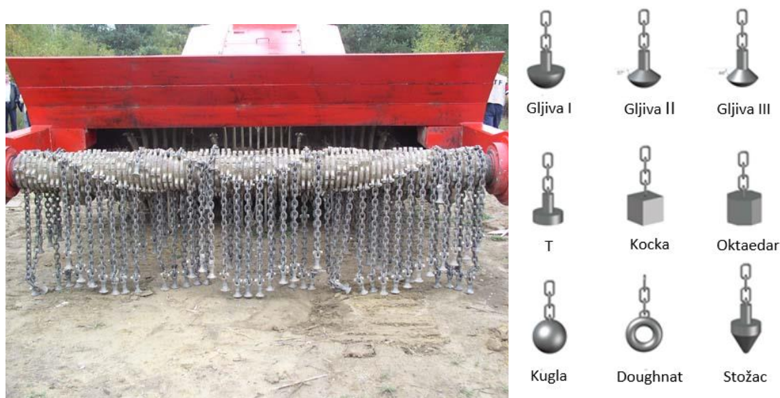
Slika 3. Alat s mlatilicama i različiti oblici mlatilica
