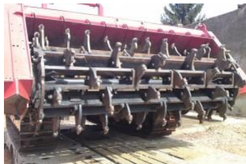
Slika 4. Alat s frezama
