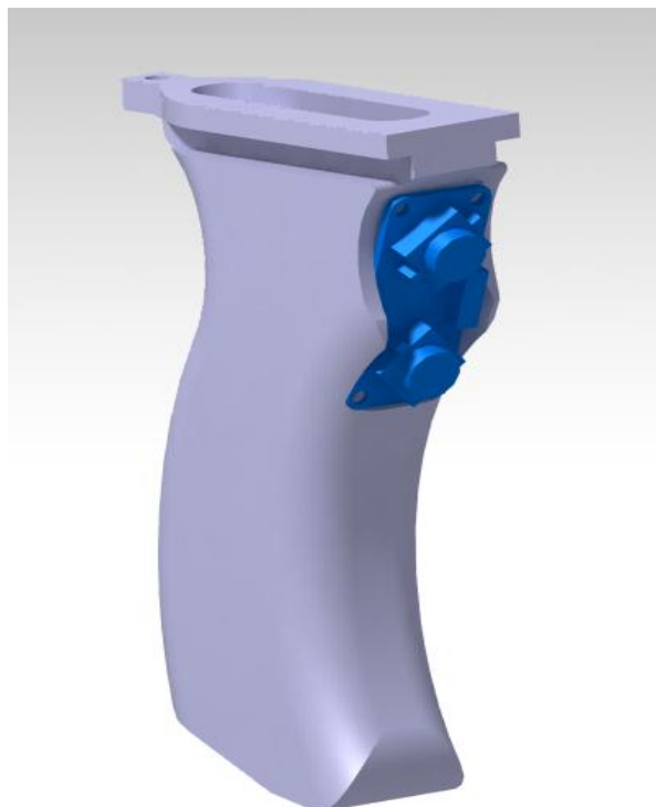
Slika 32. Prikaz sklopljene ručke i mikrokontrolera s dva upravljačka tipkala
