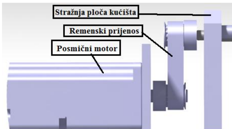
Slika 25. Remenski prijenos pri ostvarivanju posmičnog gibanja
