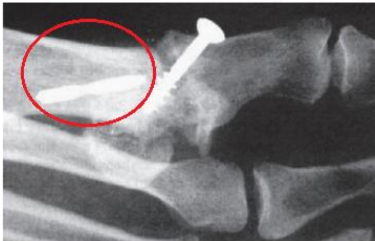
Slika 11. Slomljeni fragment svrdla zbog prevelike aksijalne sile bušenja [1]
