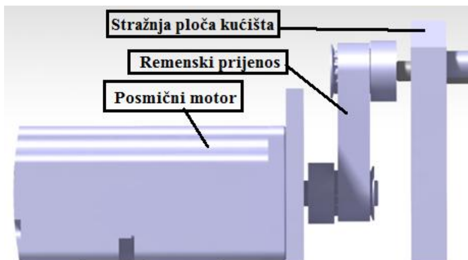
Slika 25. Remenski prijenos pri ostvarivanju posmičnog gibanja
