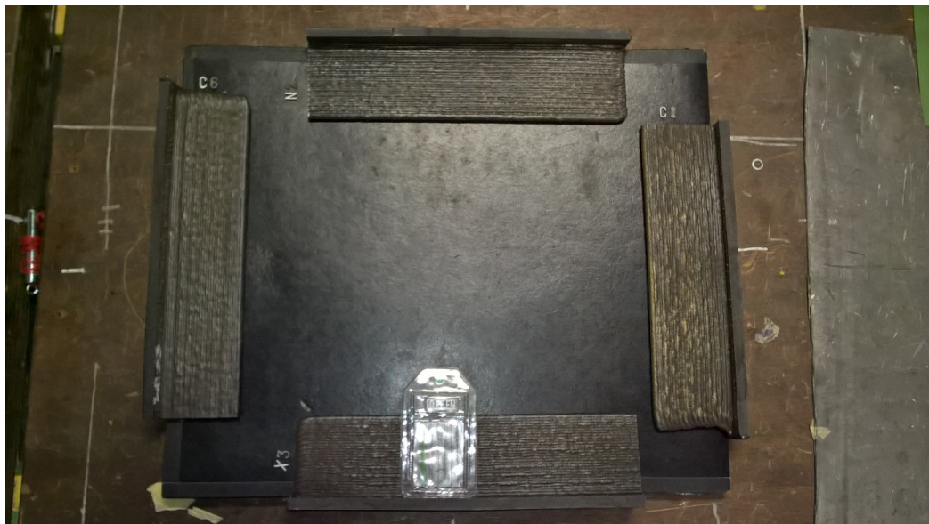
Slika 62. Postav uzoraka za radiografsko ispitivanje
