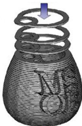
Slika 1. Ilustracija slaganja slojeva u aditivnoj proizvodnji [3]
