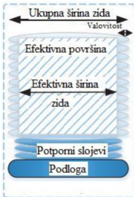
Slika 13. Presjek WAAM zida [16]
