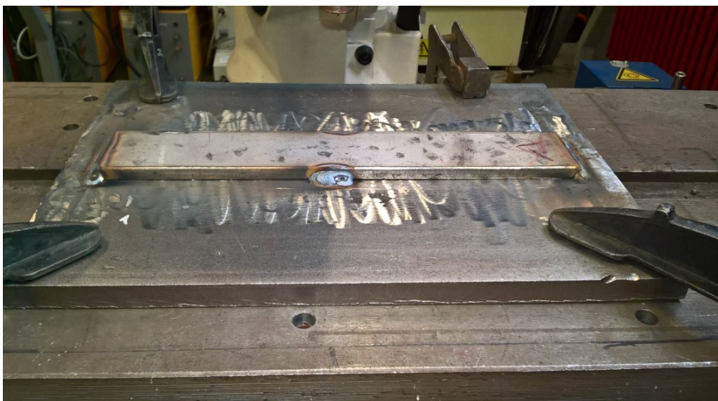
Slika 40. Pričvršćivanje ploče prije zavarivanja
