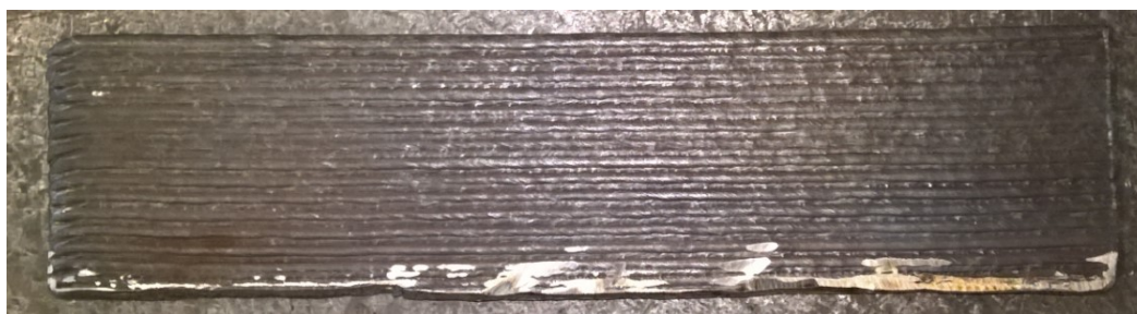
Slika 57. Odrezani zid s podloge za navarivanje
