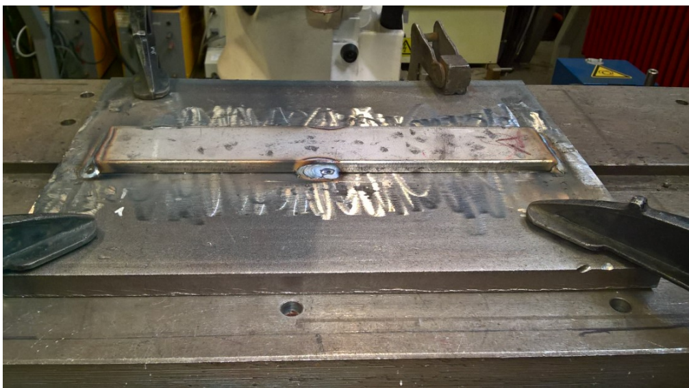
Slika 40. Pričvršćivanje ploče prije zavarivanja
