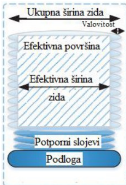
Slika 13. Presjek WAAM zida [16]
