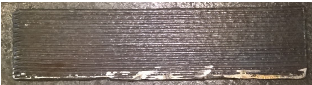
Slika 57. Odrezani zid s podloge za navarivanje
