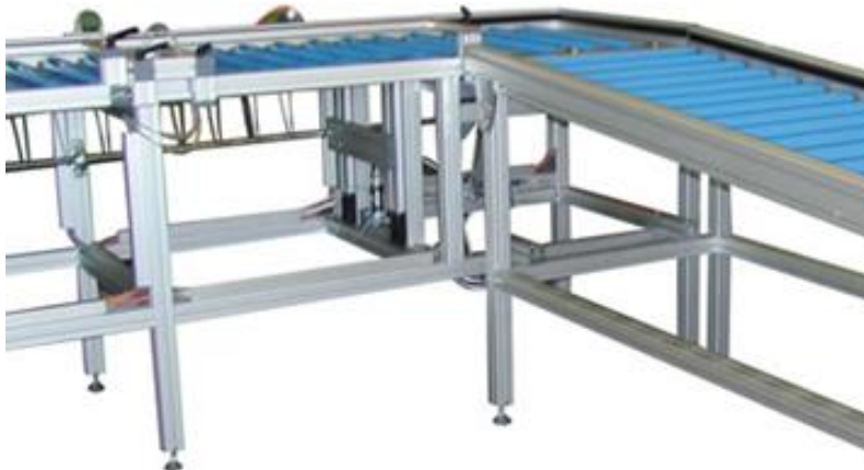
Slika 37. Primjer valjkastog konvejera s postoljem od aluminijskih profila [21]
