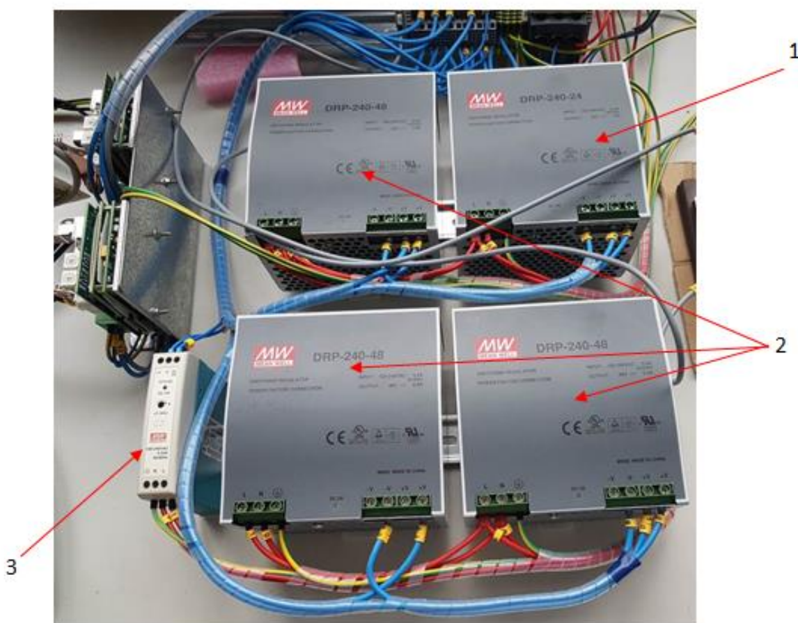
Slika 13. Komponente napajanja (1- DRP-240-24, 2- DRP-240-48, 3- MDR-20-5 )
