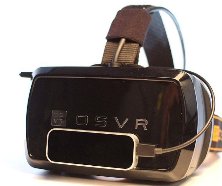
Slika 39. Kontroler Leap Motion montiran na OSVR headset [34]
