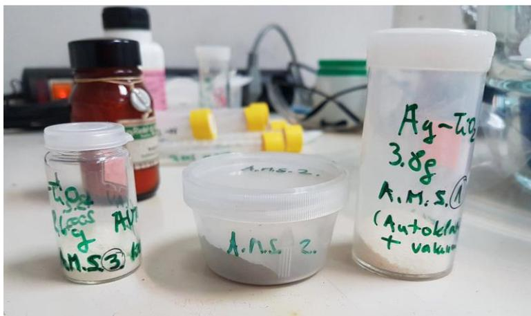
Slika 3.2. Sintetizirani i toplinski obrađeni nanostrukturirani TiO<sub>2</sub> uzorci
