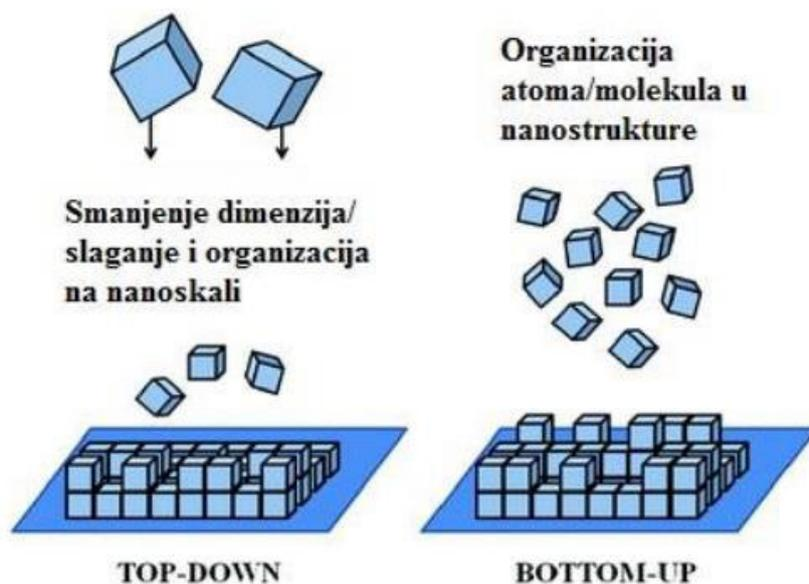
**Slika 2.5. Prikaz dva glavna pristupa za dobivanje nanomaterijala: odozgo prema dolje (engl. *top down*) i odozdo prema gore (engl. *bottom up*) [18]**
