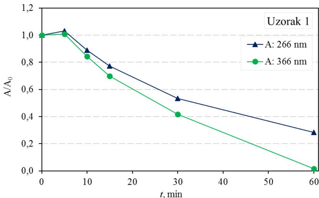
Slika 4.14. Fotokatalitička razgradnja nitrofurantoina uz primjenu uzorka 1 i VIS zračenja, mjerenjem apsorbancije pri valnoj duljini od 266 nm i 366 nm
