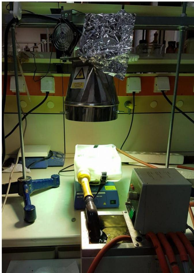
Slika 3.6. Ispitna jedinica sa SOLAR svjetiljkom
