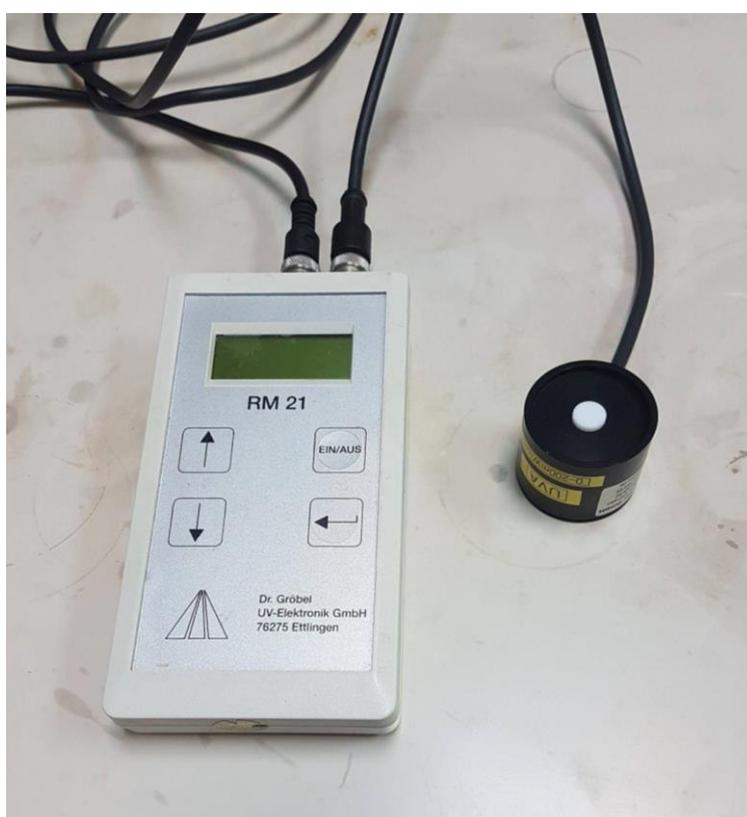
**Slika 3.7. Mobilni mjerac UV zračenja (radiometar) i sonda za mjerenje UV-A zračenja**
