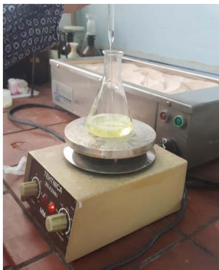
Slika 3.1. Priprava sola miješanjem reagensa magnetnim mješačem na magnetnoj miješalici
