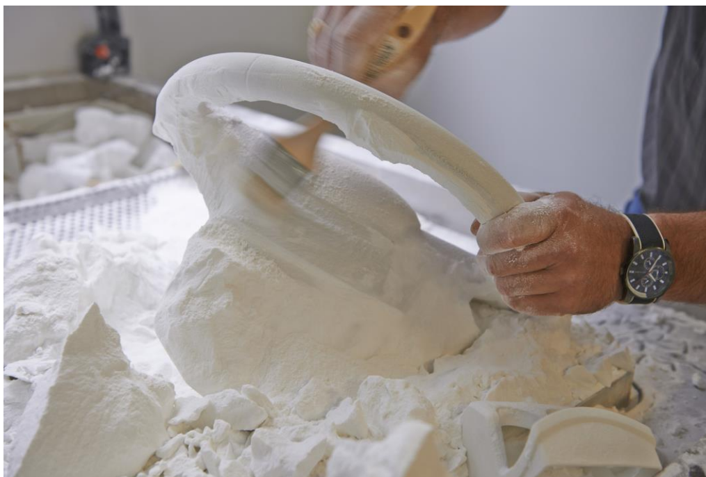
Slika 25 Model dobiven SLS postupkom
