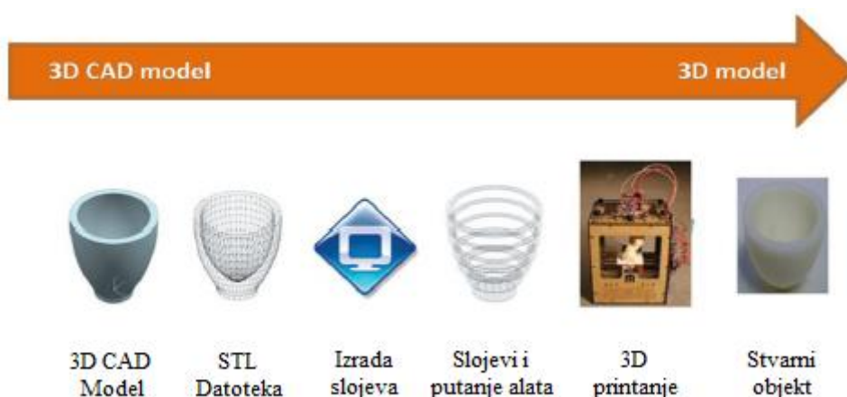
Slika 19 Faze u procesu brze izrade prototipova
