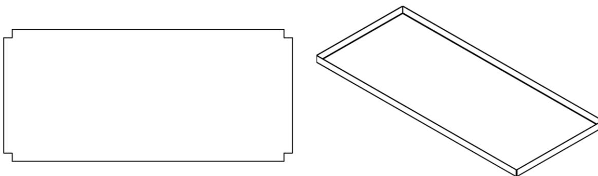
**Slika 16** Poklopac ( razvijeni oblik lijevo, savijeni desno)
