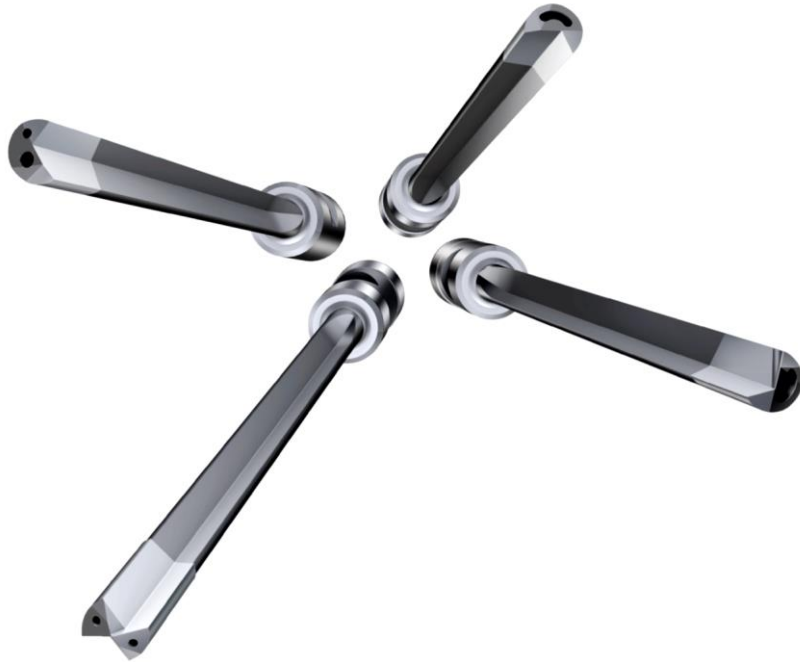
Slika 13. Topovska svrdla s različitim brojem reznih oštrica [13]
