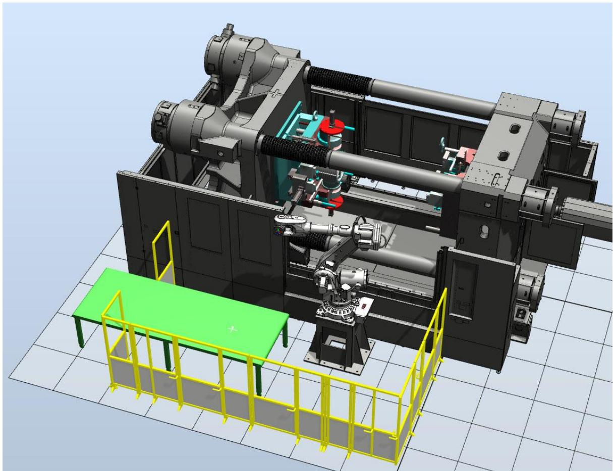
**Slika 17. Robotska stanica sa ogradom i transportnom trakom**
