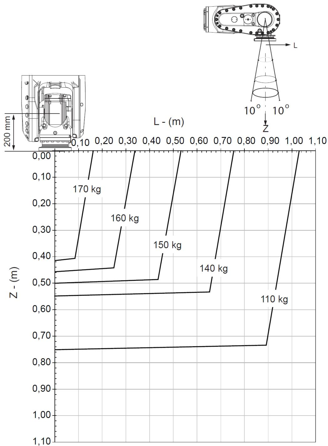
Slika 24. Dijagram nosivosti robota – prirubnica prema dolje
