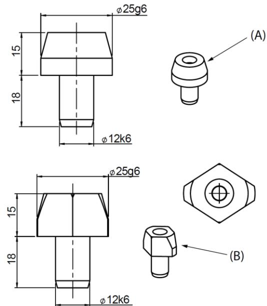
**Slika 38. Konusni trnovi za centriranje robota**
