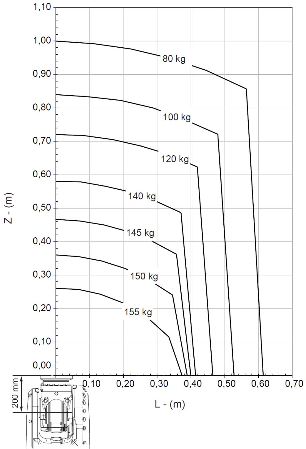
Slika 25. Dijagram nosivosti robota – prirubnica horizontalno
