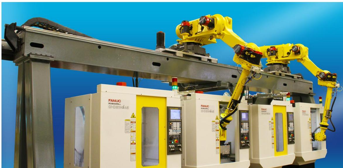
**Slika 10. Roboti na linearnoj jedinici postavljeni iznad stroja**
