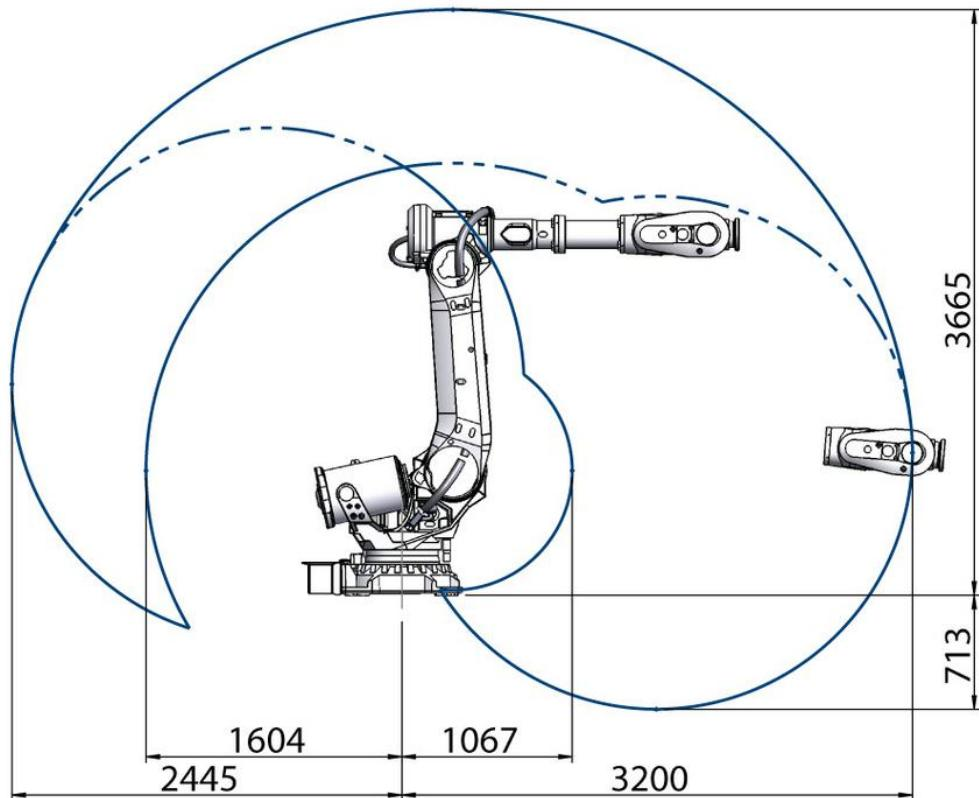
**Slika 15. Radni prostor robota ABB IRB 6700 3.2/150**
