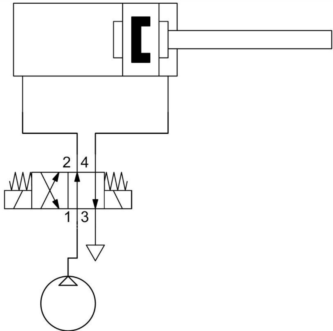
Slika 36. Pneumatska shema pokretanja cilindra
