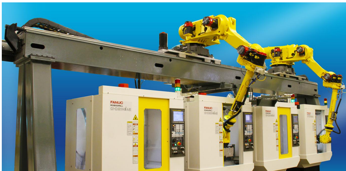
Slika 10. Roboti na linearnoj jedinici postavljeni iznad stroja
