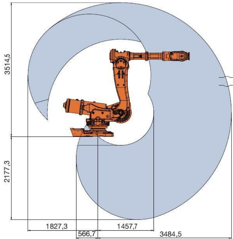
Slika 11. Radni prostor robota ABB IRB 6650S 3.5m
