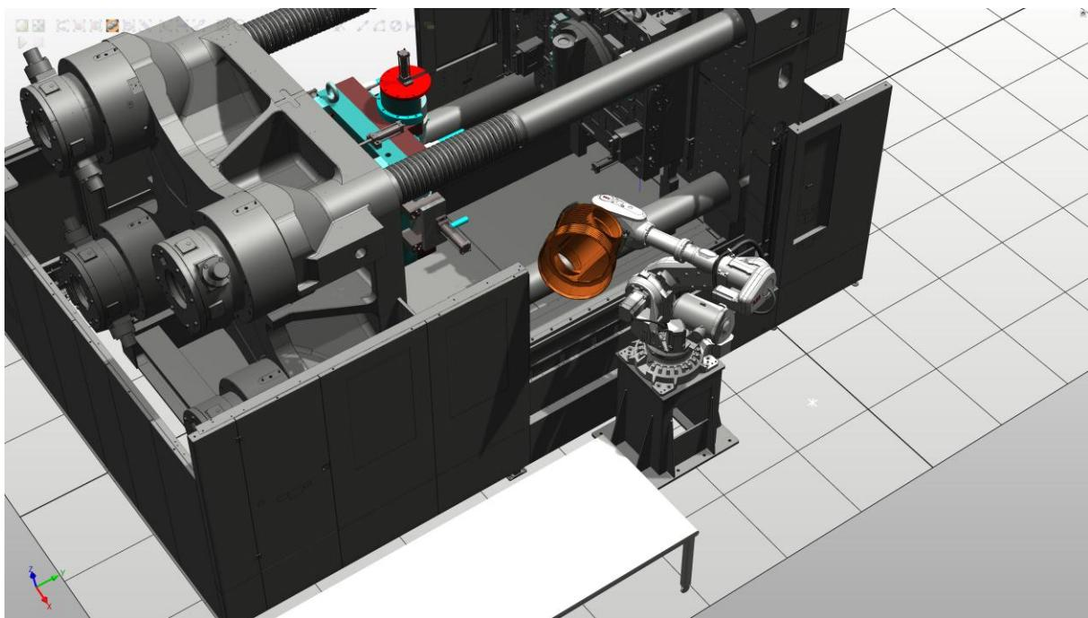
Slika 20. Provjera kolizije pri izlazu iz stroja
